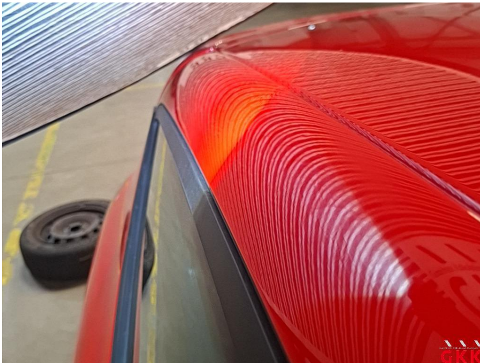
Bild 37 Dach, Holm rechts, beschädigt, kalt drücken
