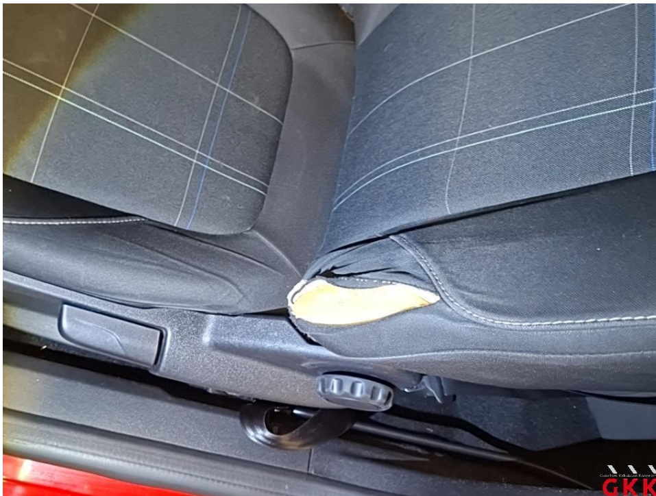
Bild 16 Sitz vorne links, Bezug Rückenlehne -Stoff-, beschädigt, ersetzen
