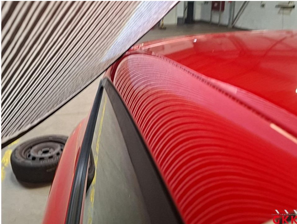
Bild 38 Dach, Holm rechts, beschädigt, kalt drücken
