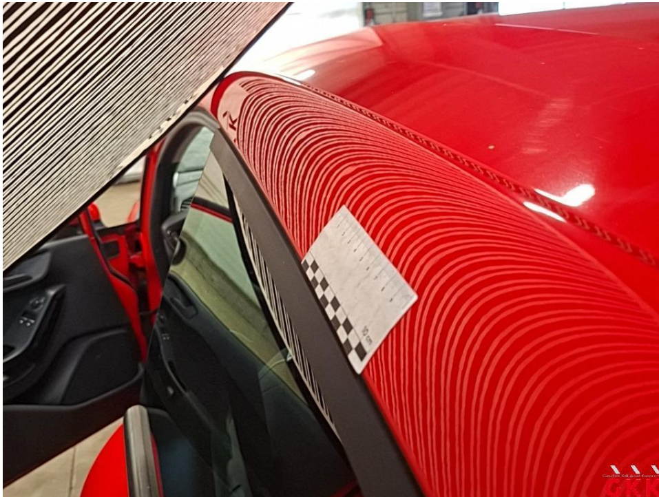
Bild 27 Dach, Holm links, beschädigt, kalt drücken
