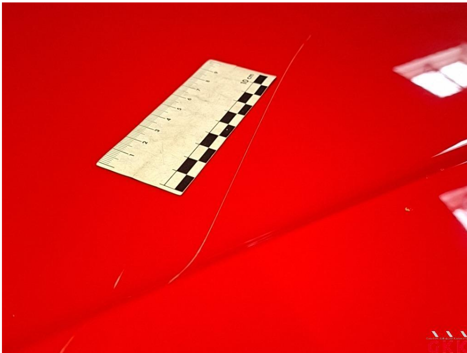
Bild 24 Dach, beschädigt, instand setzen - lackieren
