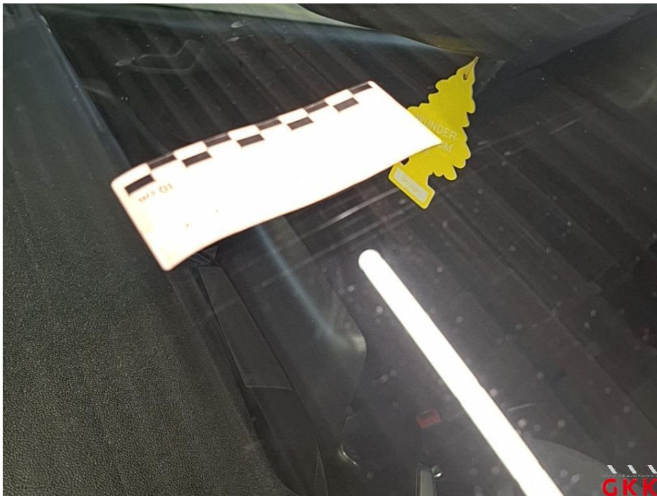
Bild 49 Frontscheibe, mit Regensensor und Frontkamera, verkratzt, ersetzen
