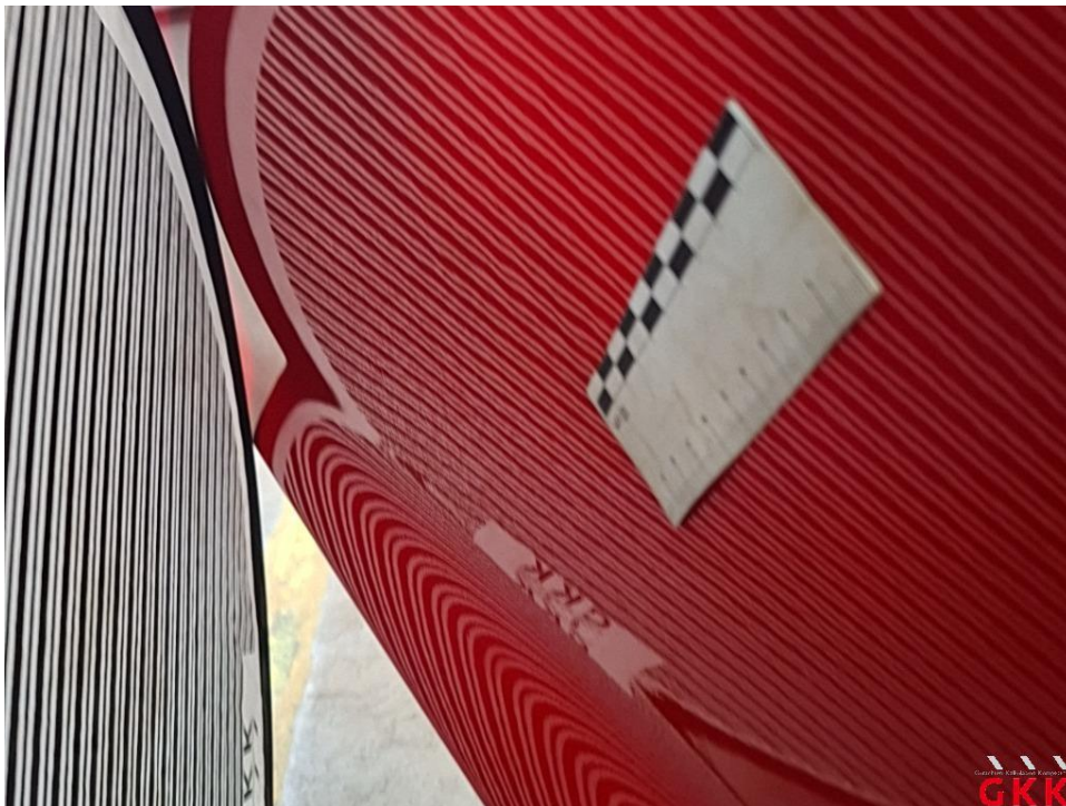
Bild 47 Tür vorne rechts, Reparaturmangel, instand setzen - lackieren
