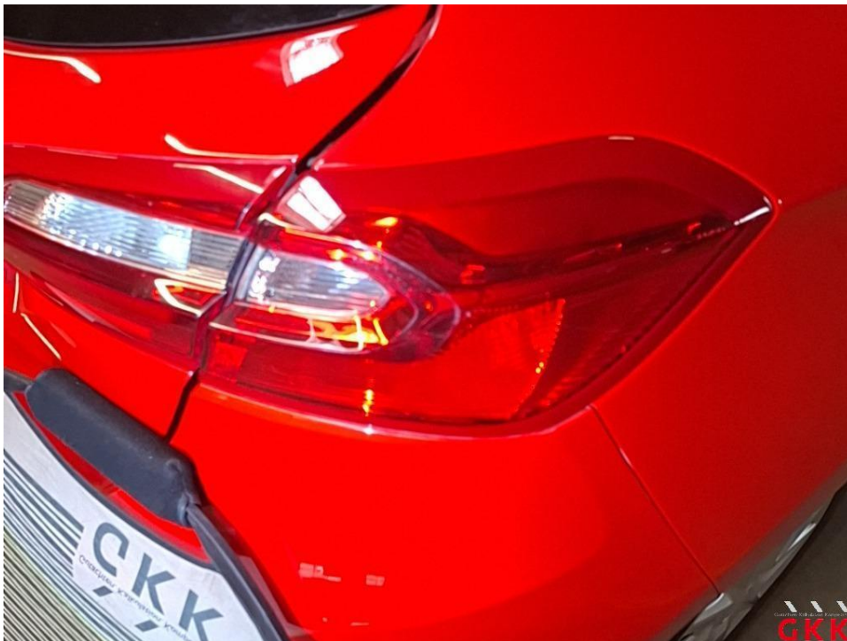
Bild 28 Rückleuchte rechts, außen, verkratzt, ersetzen
