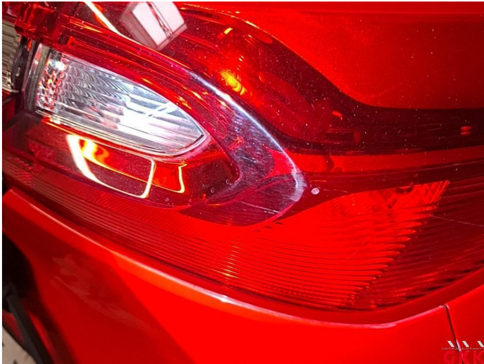
Bild 29 Rückleuchte rechts, außen, verkratzt, ersetzen
