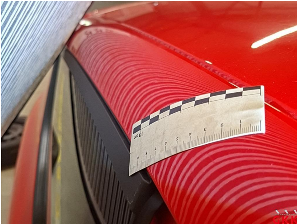
Bild 36 Dach, Holm rechts, beschädigt, kalt drücken
