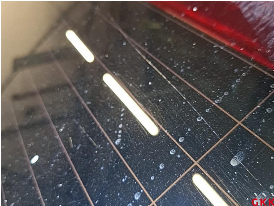
Bild 31 Heckscheibe, verkratzt, ersetzen
