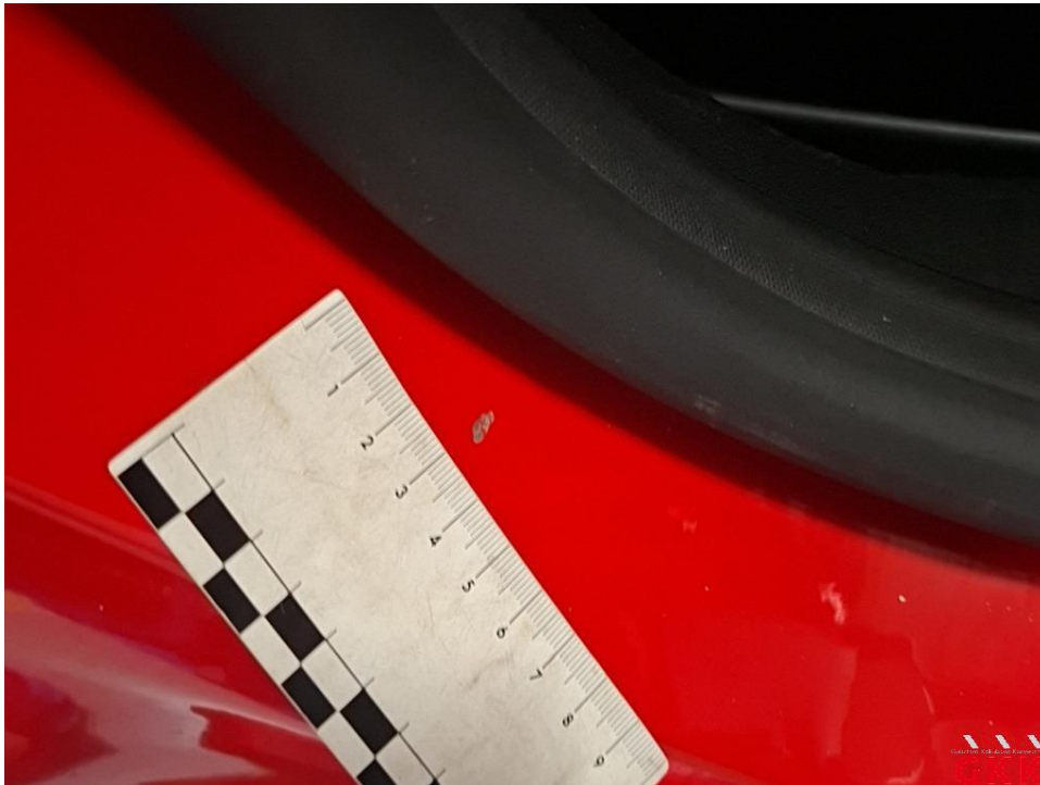
Bild 40 Tür vorne rechts, Einstieg, verkratzt, Spotlackieren
