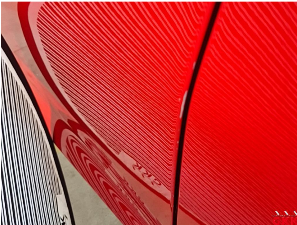
Bild 43 Tür vorne links, beschädigt, instand setzen - lackieren
