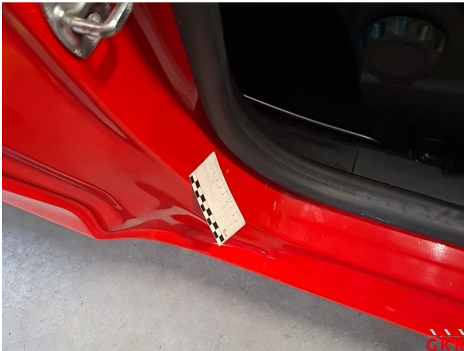
Bild 39 Tür vorne rechts, Einstieg, verkratzt, Spotlackieren
