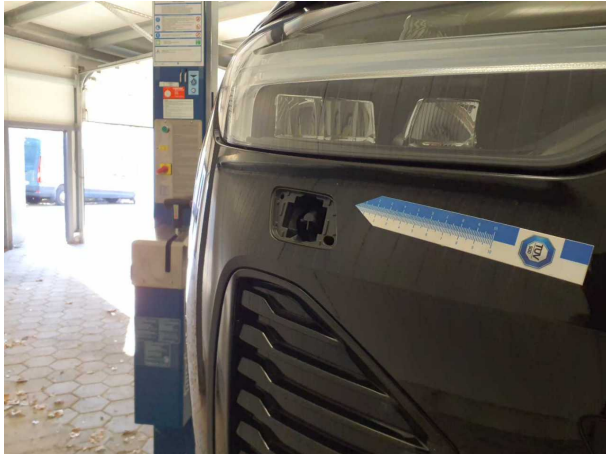
Beschädigung #1: Scheinwerfer: Scheinwerferreinigungsdüse rechts (Abdeckkappe) - fehlt - erneuern
