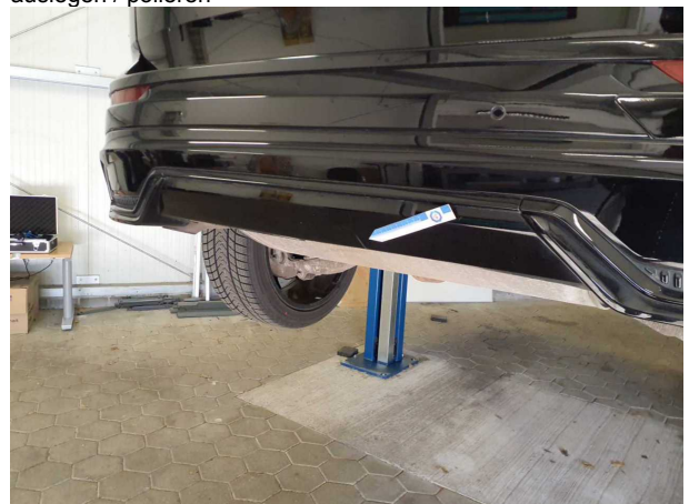
Beschädigung #4: Stossfänger hinten: Spoiler - Kratzer - Smart Repair
