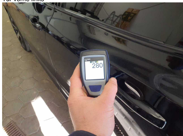
Nachlackierung 1: Dachholm links, Seitenwand links, Tür hinten links, Tür vorne links
