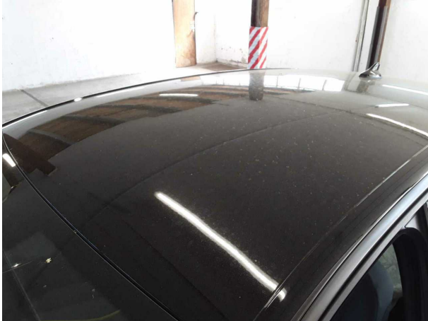
Beschädigung #4: Fahrzeugdach: Dach - Delle(n) - sanft instandsetzen
