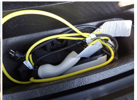
Elementos faltantes / Cable de carga rápida (Type 2, Mode 3)
