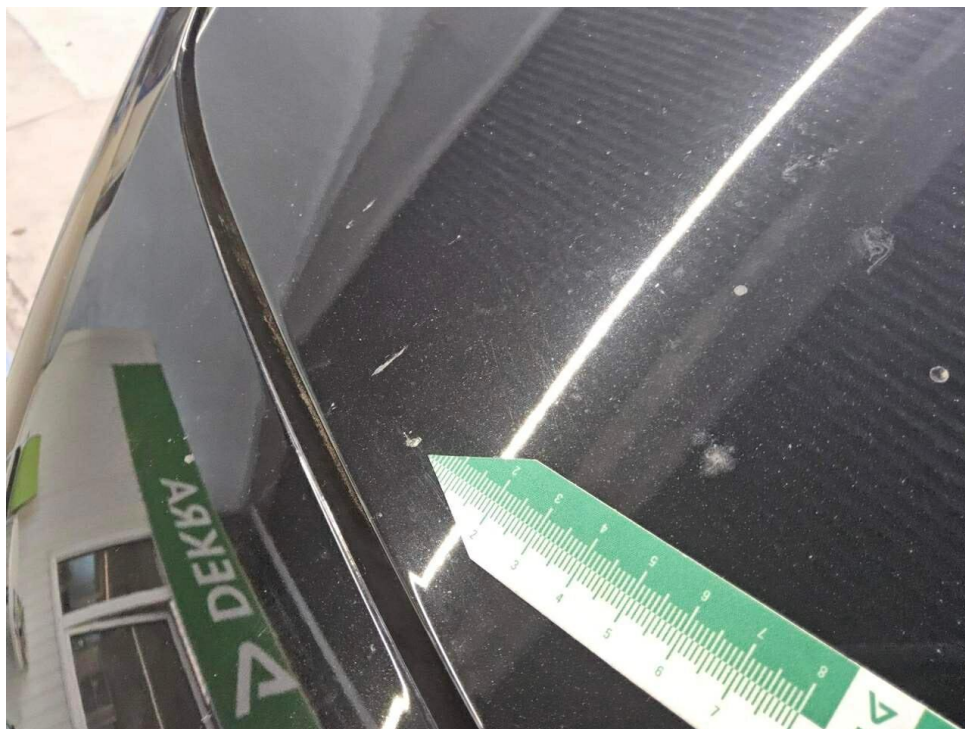
Bild 19 : Motorhaube Lackierung, Steinschlag, Gebrauchsspur
