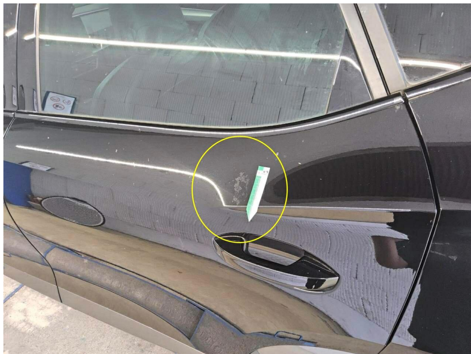
Bild 14 : Tür hinten links Lackierung, Umweltschaden, lackieren mit Lackaufbau
