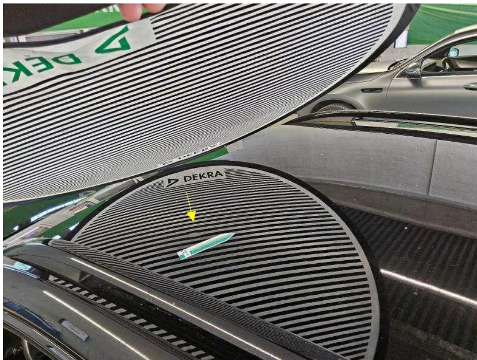
Bild 29 : Dach, mehrfach eingedellt, drücken
