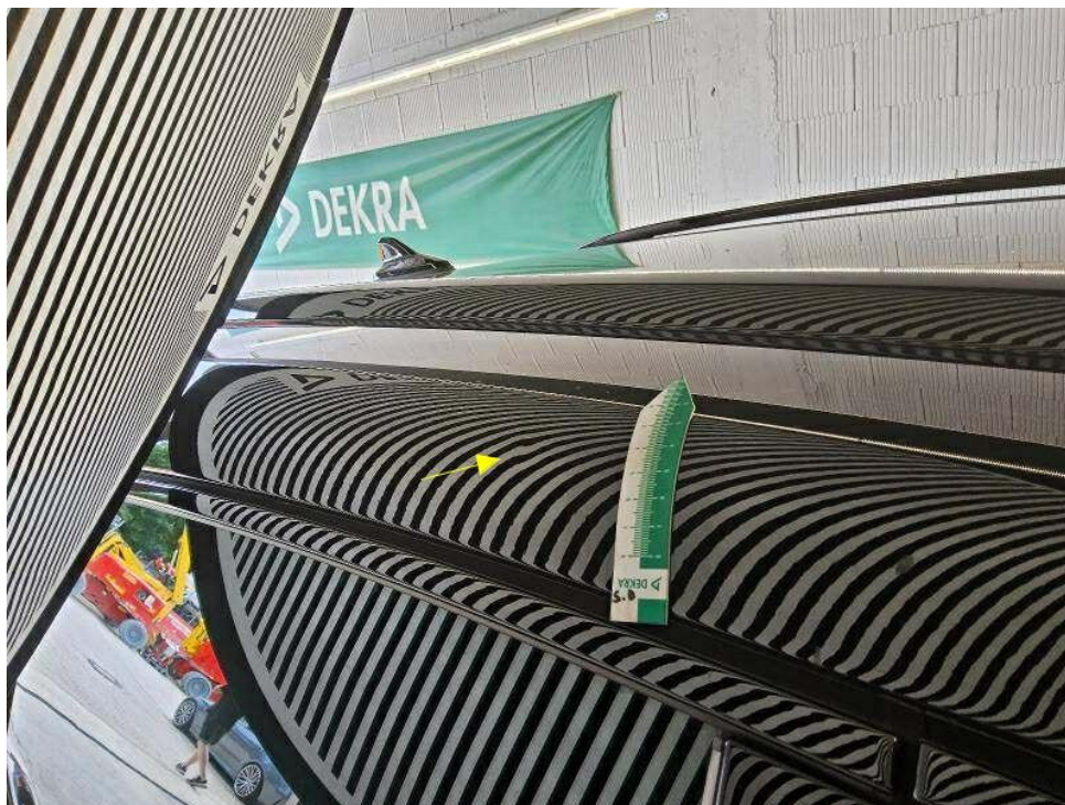
Bild 33 : Dachrahmen rechts, eingedellt, drücken
