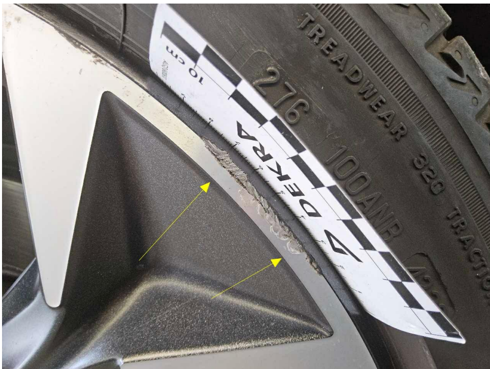
Bild 26 : LM Felge vorne rechts glanzgedreht verschrammt
