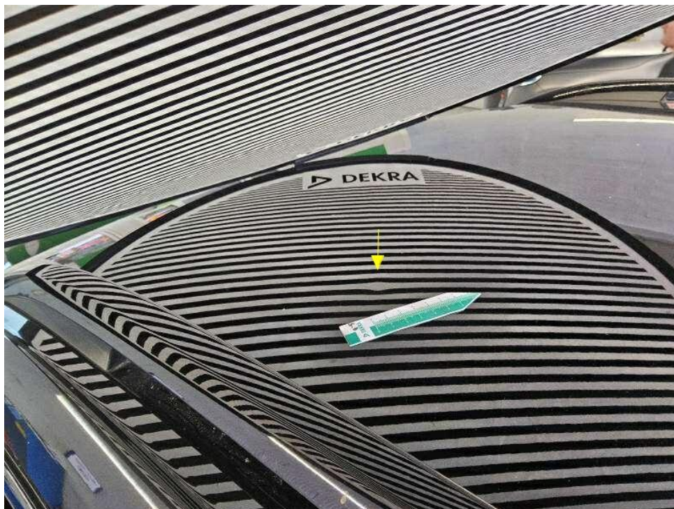
Bild 27 : Dachrahmen rechts, eingedellt, drücken
