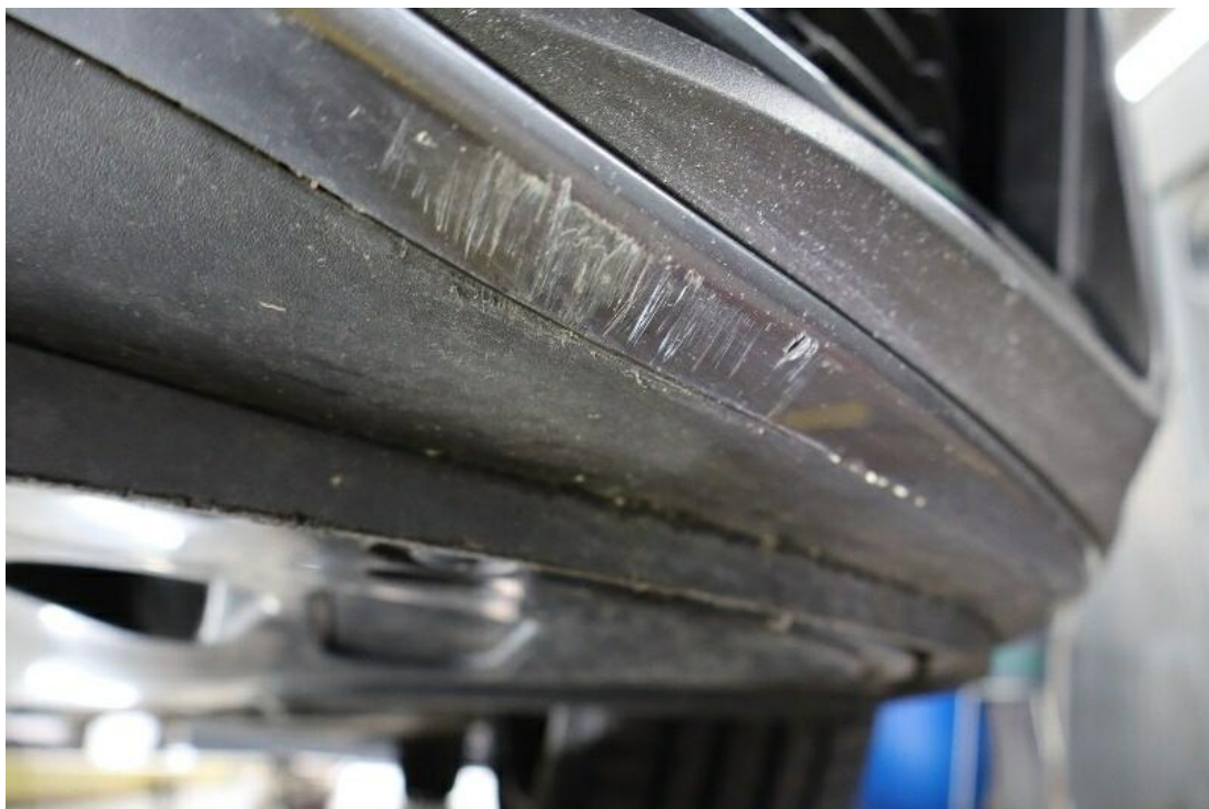
Bild 21 : Stoßfängerverkleidung vorn unterhalb verkratzt
