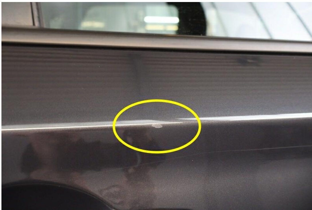
Bild 19 : Tür hinten rechts verkratzt
