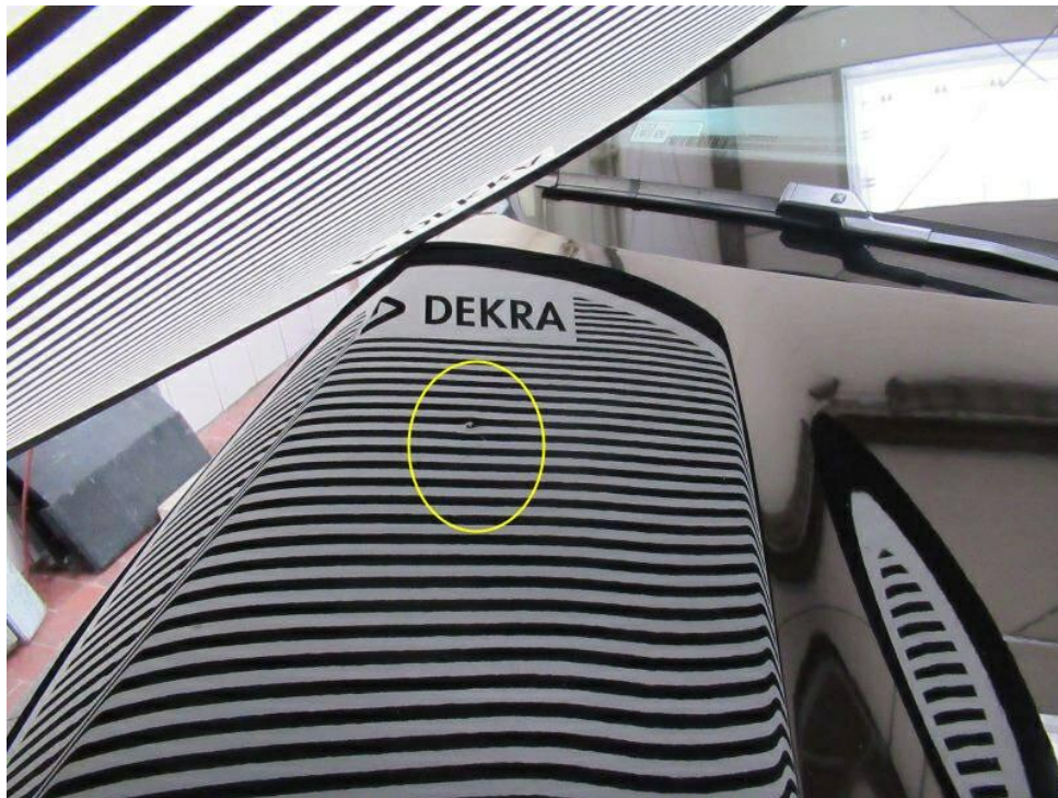
Bild 13 : Motorhaube rechts eingedellt
