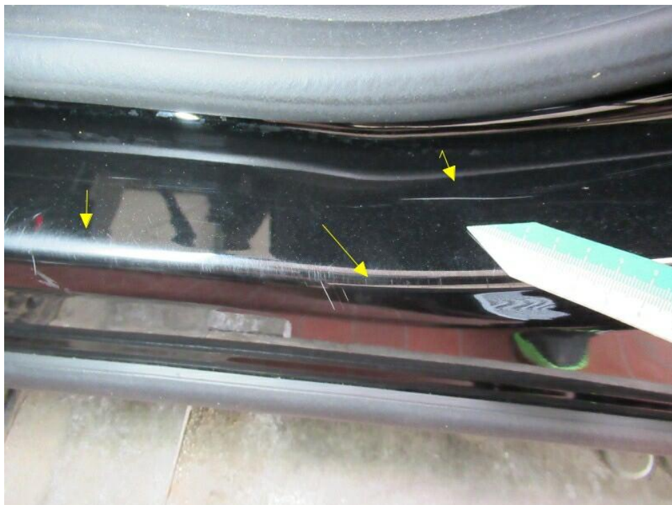
Bild 14 : Türeinstieg vorn links zerkratzt
