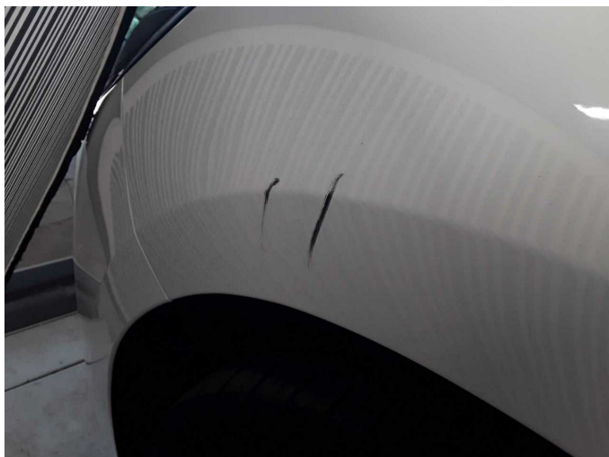
Damage 7: Mudguard - left side: Mudguard - left side (Delle auf der Kante) - dent(s) - Repair and paint
