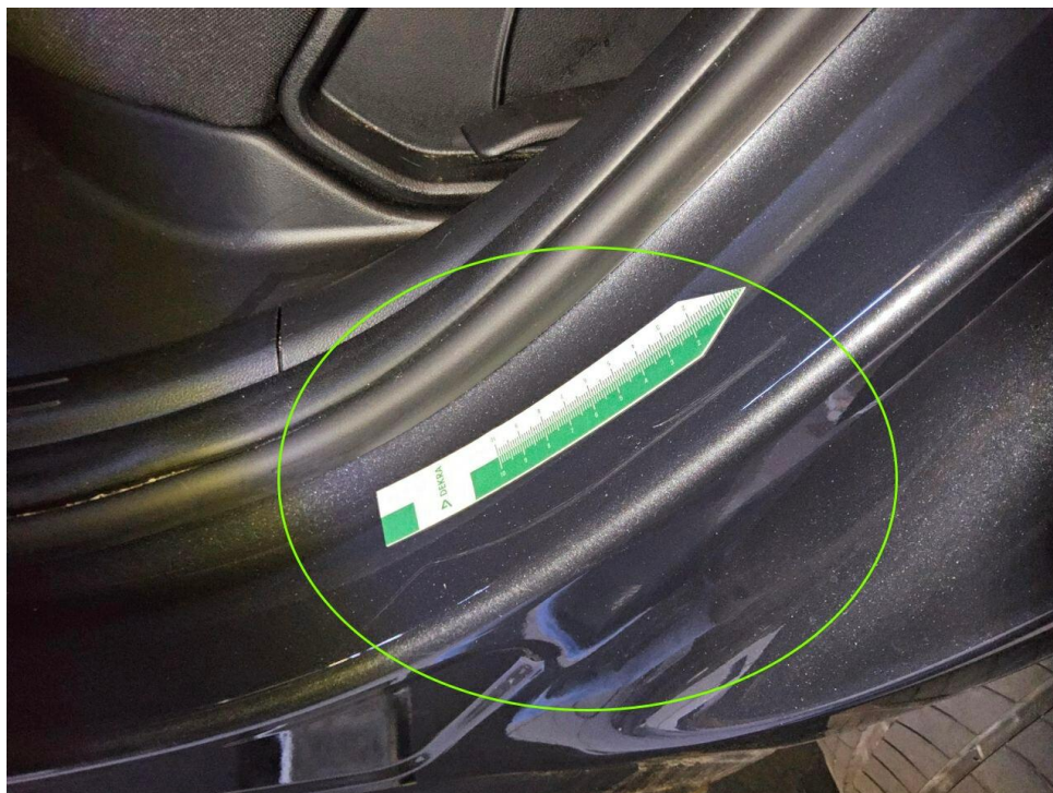
Bild 10 : Tür hinten links Einstieg Lackierung, zerkratzt, polieren
