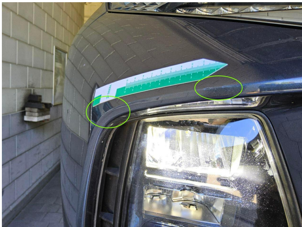
Bild 14 : Stoßfänger vorne Lackierung, verschrammt, lackieren mit Lackaufbau
