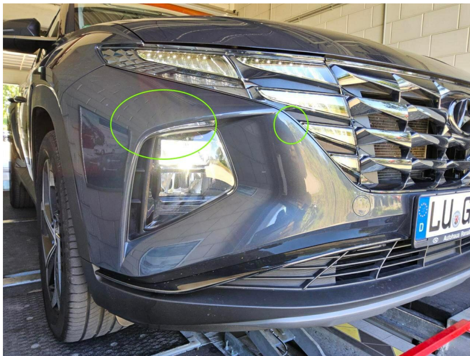
Bild 12 : Stoßfänger vorne Lackierung, verschrammt, lackieren mit Lackaufbau
