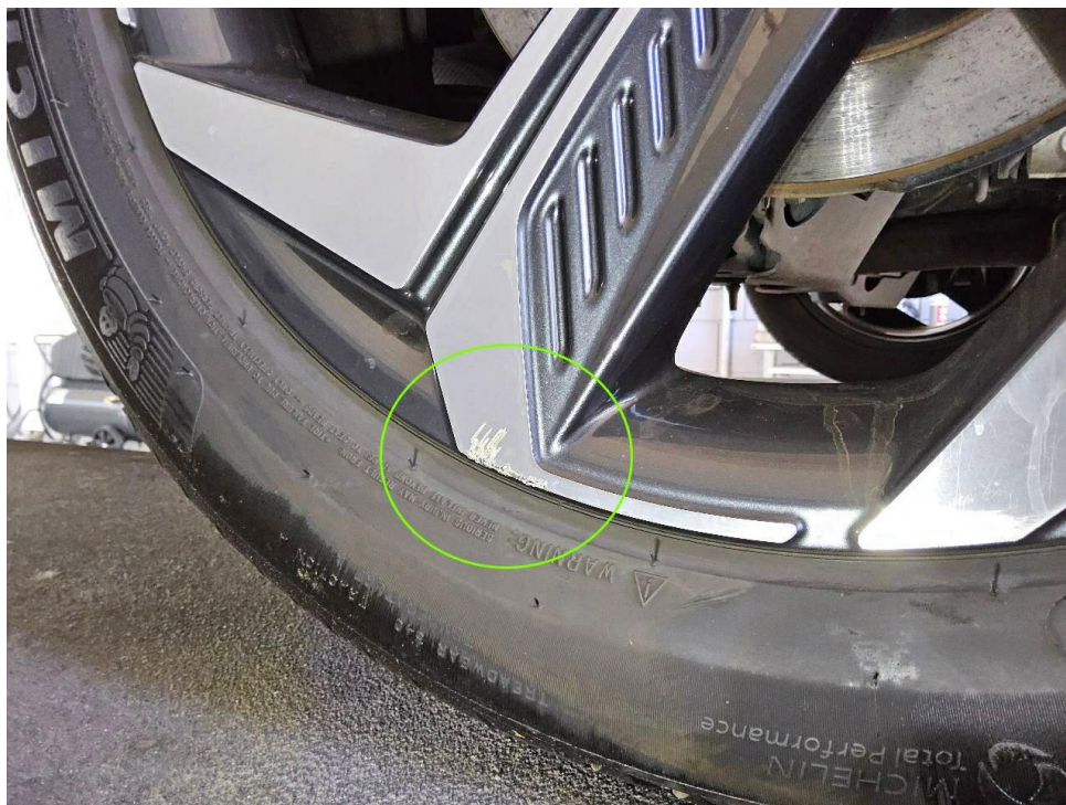
Bild 15 : Felge hinten rechts verschrammt, glanzgedreht
