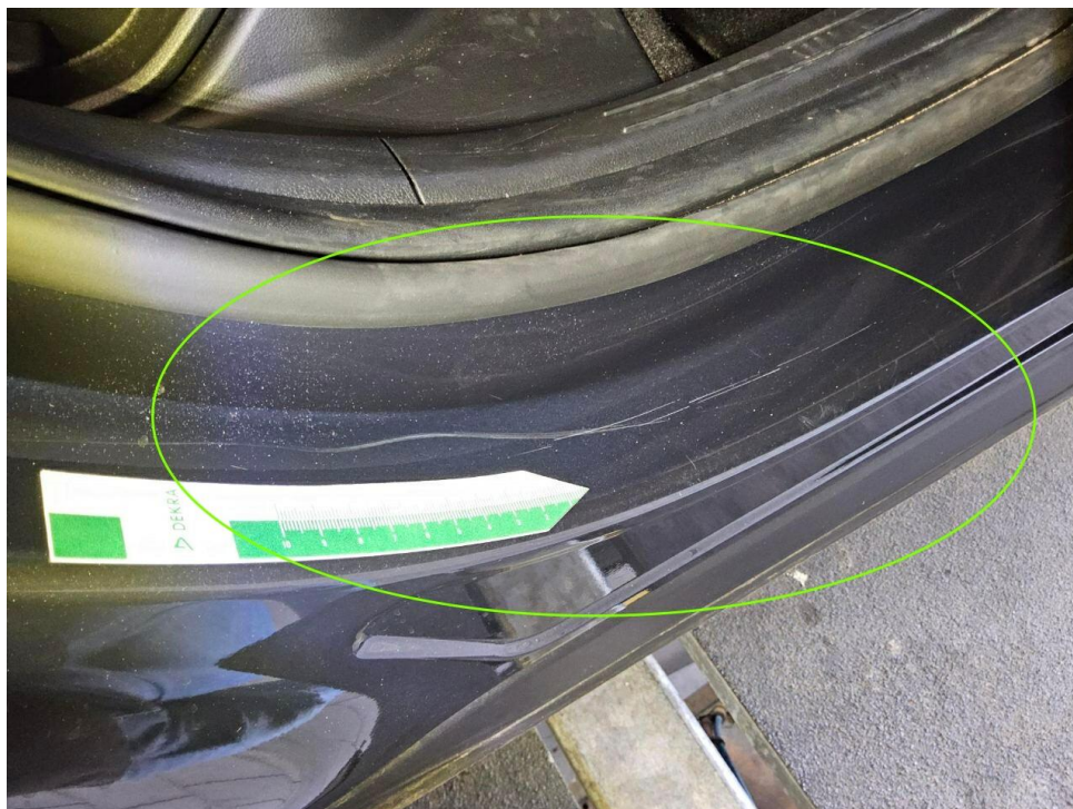
Bild 16 : Tür hinten rechts Einstieg Lackierung, zerkratzt, polieren
