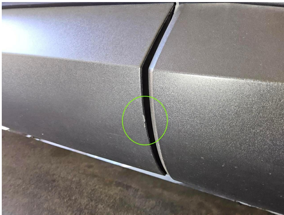
Bild 11 : Tür vorne links Türkante, verschrammt, Gebrauchsspur
