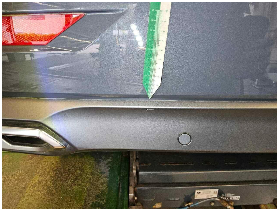
Bild 15 : Heckschürze hinten unten, zerkratzt, Gebrauchsspur
