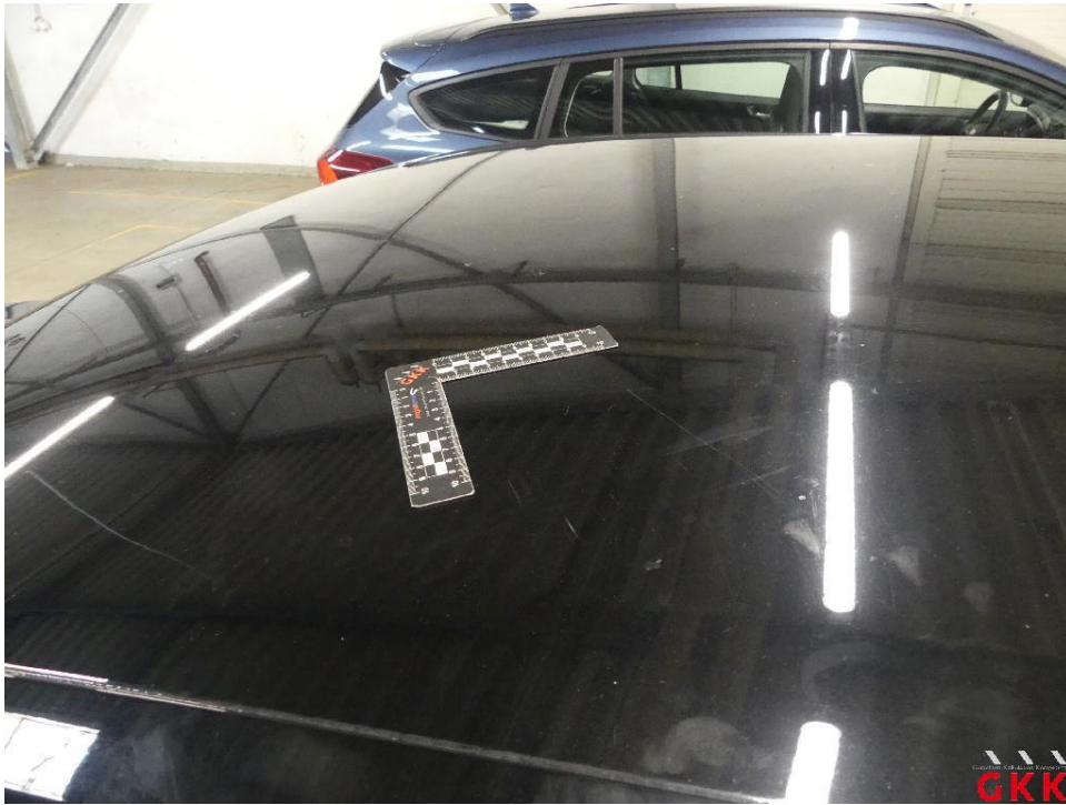
Bild 21 Dach, verkratzt, lackieren
