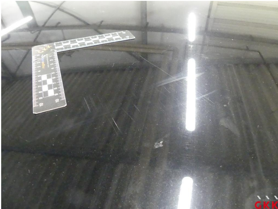
Bild 23 Dach, verkratzt, lackieren
