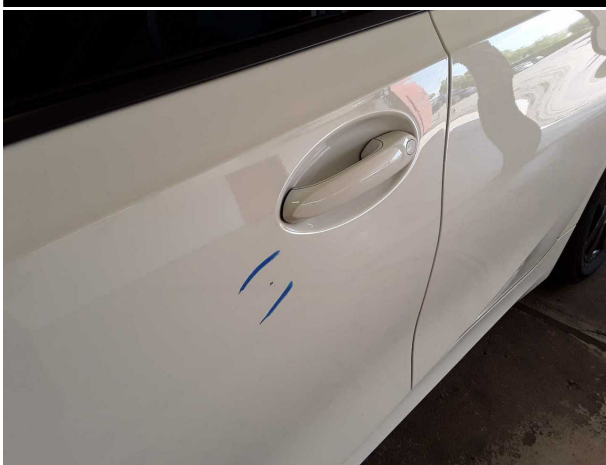
Beschädigung #5: Tür vorn links: Tür - verkratzt / verschürft - instandsetzen und lackieren
