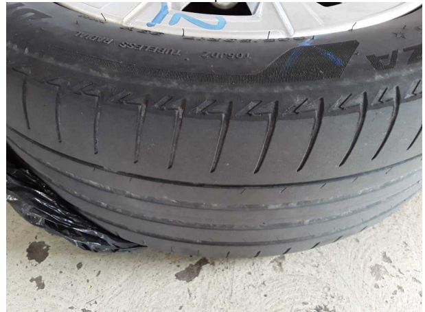
Beschädigung #3: 2.Radsatz: Reifensatz komplett - verschlissen - erneuern
