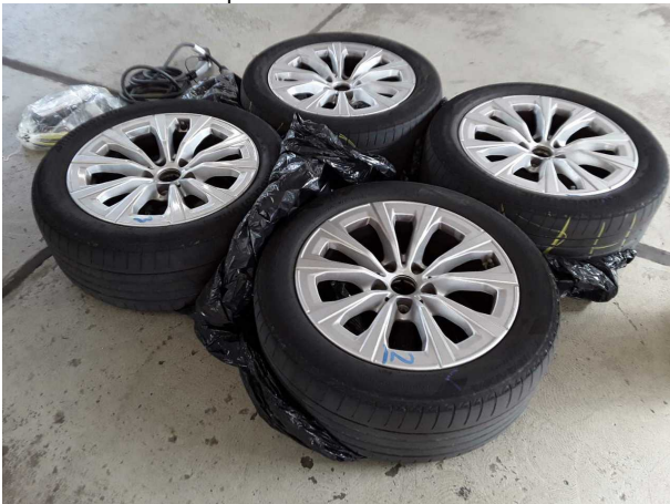
Beschädigung #3: 2.Radsatz: Reifensatz komplett - verschlissen - erneuern
