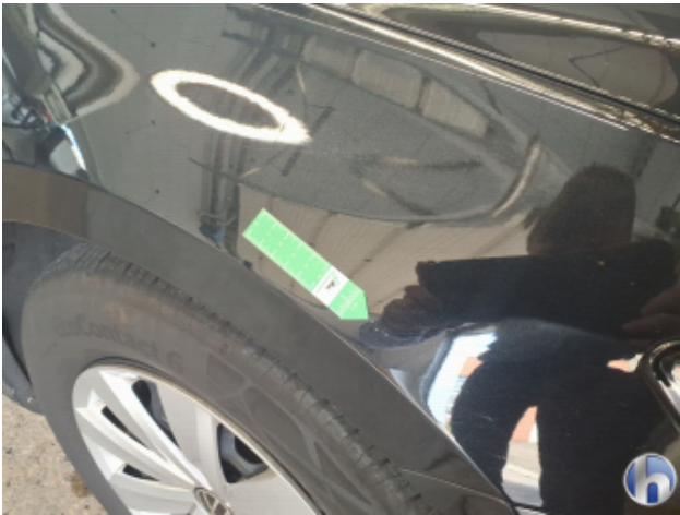
2. Kotflügel Vorne - Rechts Steinschlag - Smart Repair
