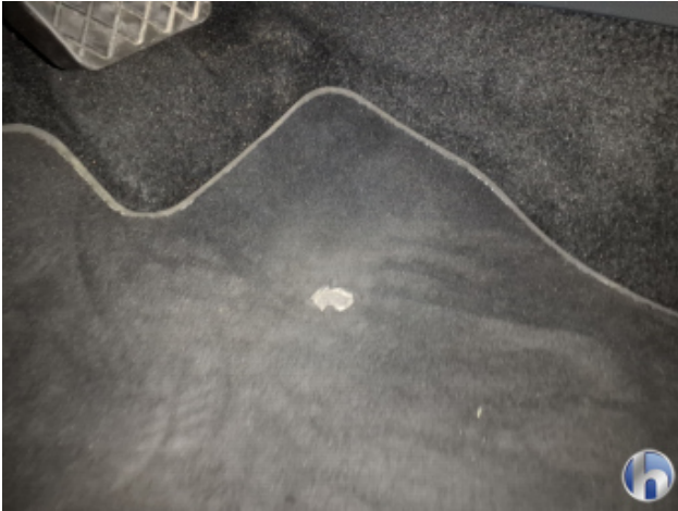
7. Fußraum Innenraum links vorne Loch - Erneuern
