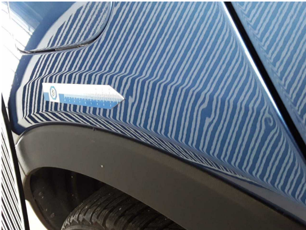
Beschädigung #2: Seitenwand rechts: Seitenwand - Delle(n) - sanft instandsetzen
