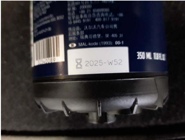
Beschädigung #1: Ausrüstung: Tirefit Füllmittel - abgelaufen - erneuern
