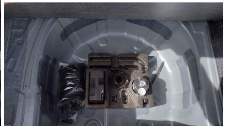
Elementos faltantes / Kit de reparación de neumáticos de recarga
