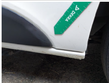
Tür / Vorne Rechts / Kratzer
