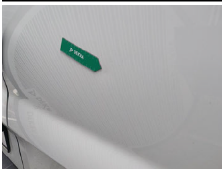
Heckklappe / Kofferraumtür / Rechts / Delle
