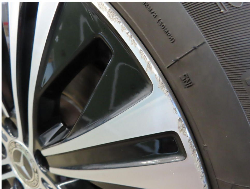
Bild 13 : LM Felge vorne links Kratzer (Glanzgedreht)
