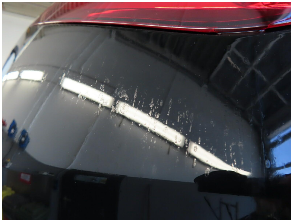
Bild 7 : Stoßfänger hinten Lackierung, Umweltschaden, lackieren
