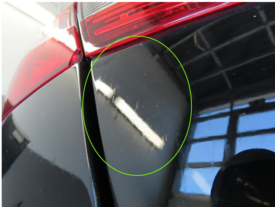
Bild 8 : Heckklappe Lackierung, Umweltschaden, lackieren
