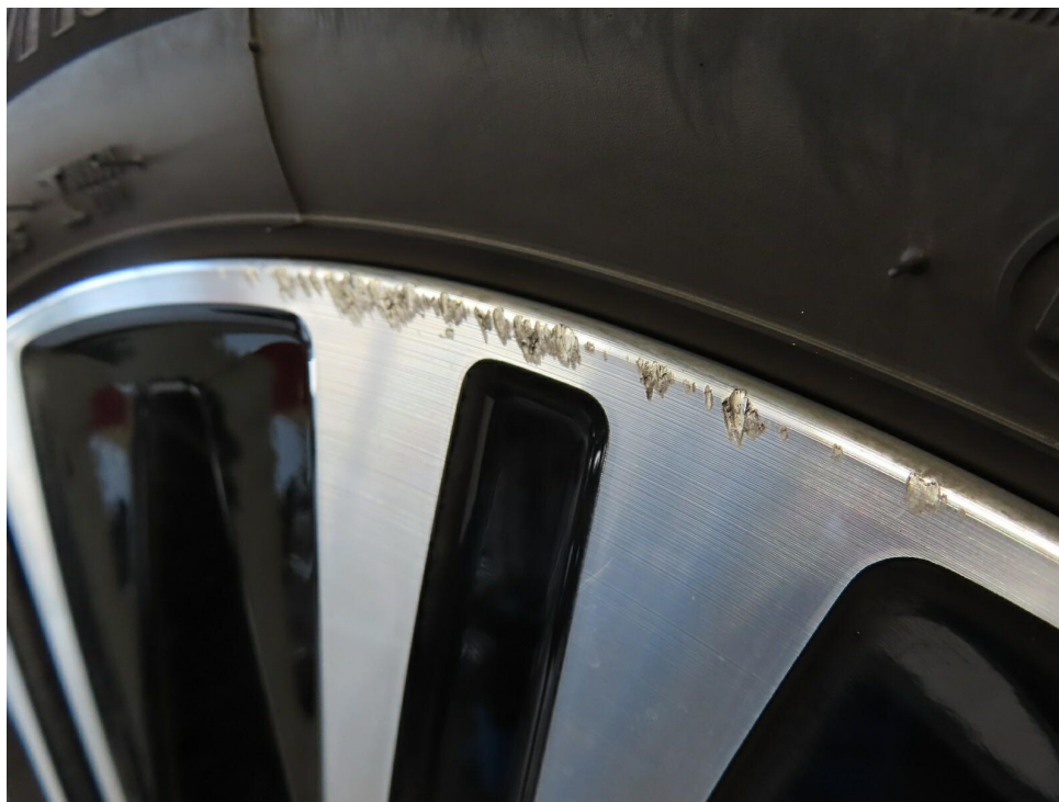
Bild 6 : LM Felge vorne rechts Kratzer (Glanzgedreht)
