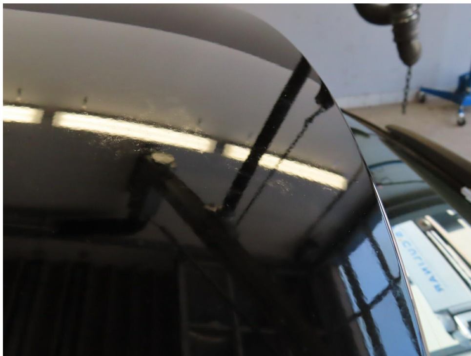
Bild 10 : Heckspoiler Lackierung, Umweltschaden, lackieren
