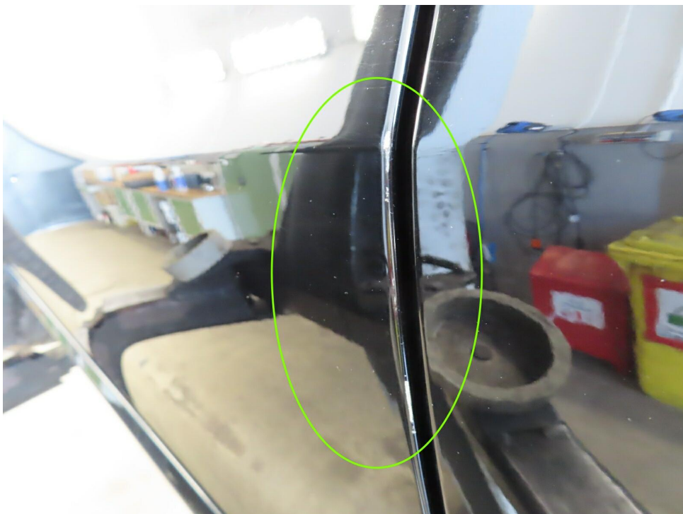
Bild 12 : Tür vorne links Lackierung, zerkratzt, smart repair
