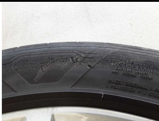
Beschädigung #7: 2.Radsatz: 2 Reifen - porös / rissig - erneuern
