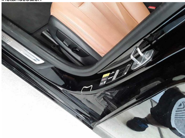
Beschädigung #2: Schweller links: Einstieg - Delle(n) - sanft instandsetzen
