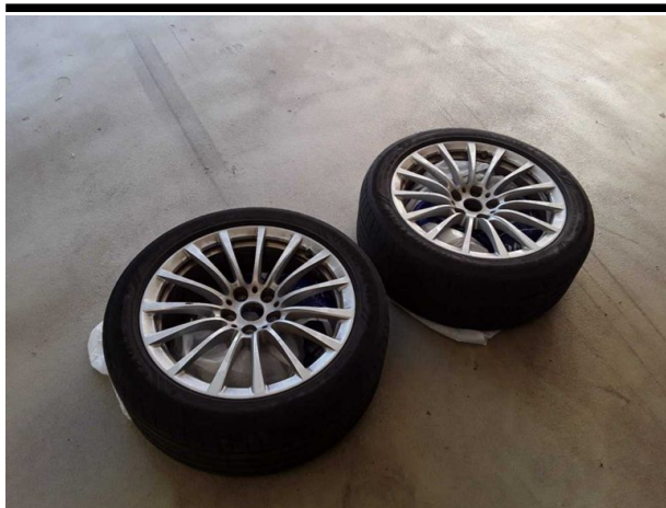
Beschädigung #7: 2.Radsatz: 2 Reifen - porös / rissig - erneuern
