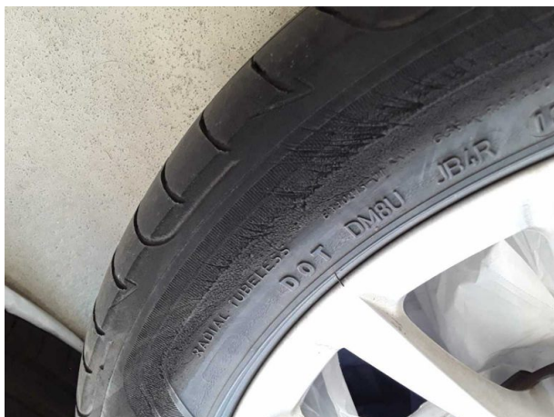
Beschädigung #7: 2.Radsatz: 2 Reifen - porös / rissig - erneuern
