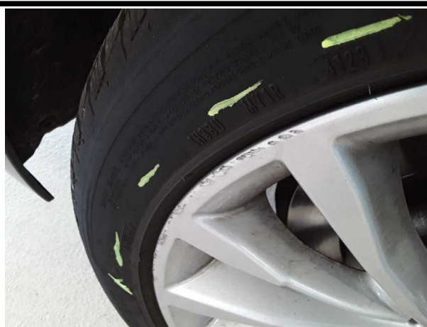
Beschädigung #4: Rad/Reifen: Leichtmetallfelge hinten rechts - verkratzt / verschürft - Wertminderung
