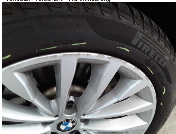
Beschädigung #5: Rad/Reifen: Leichtmetallfelge vorn links - verkratzt / verschürft - Wertminderung
