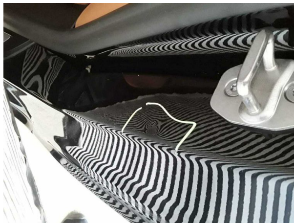
Beschädigung #1: Seitenwand links: Einstieg - Delle(n) - sanft instandsetzen
