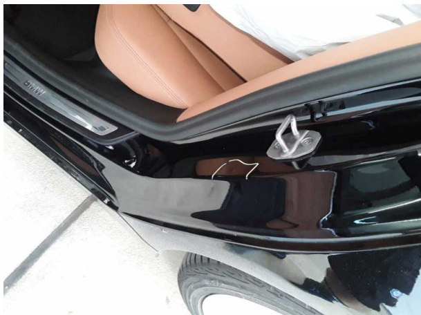
Beschädigung #1: Seitenwand links: Einstieg - Delle(n) - sanft instandsetzen
