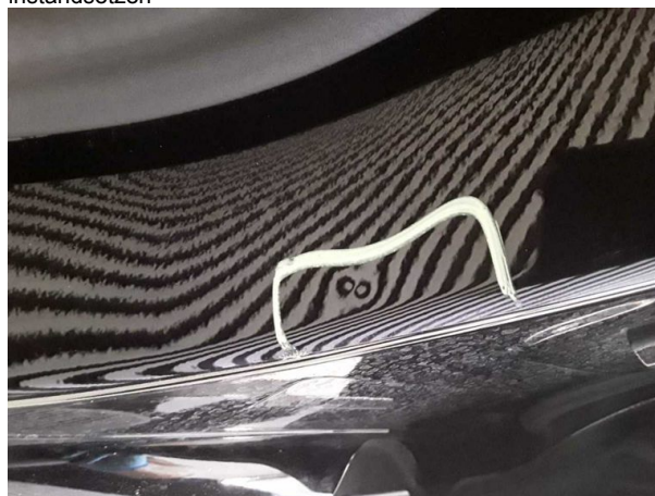
Beschädigung #2: Schweller links: Einstieg - Delle(n) - sanft instandsetzen
