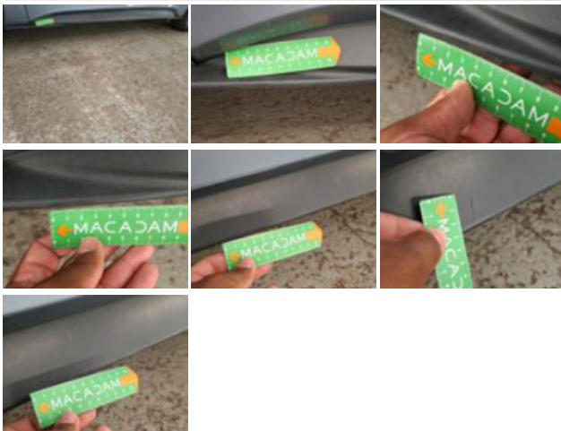
Aile AVG, Mauvaise réparation, Peindre
