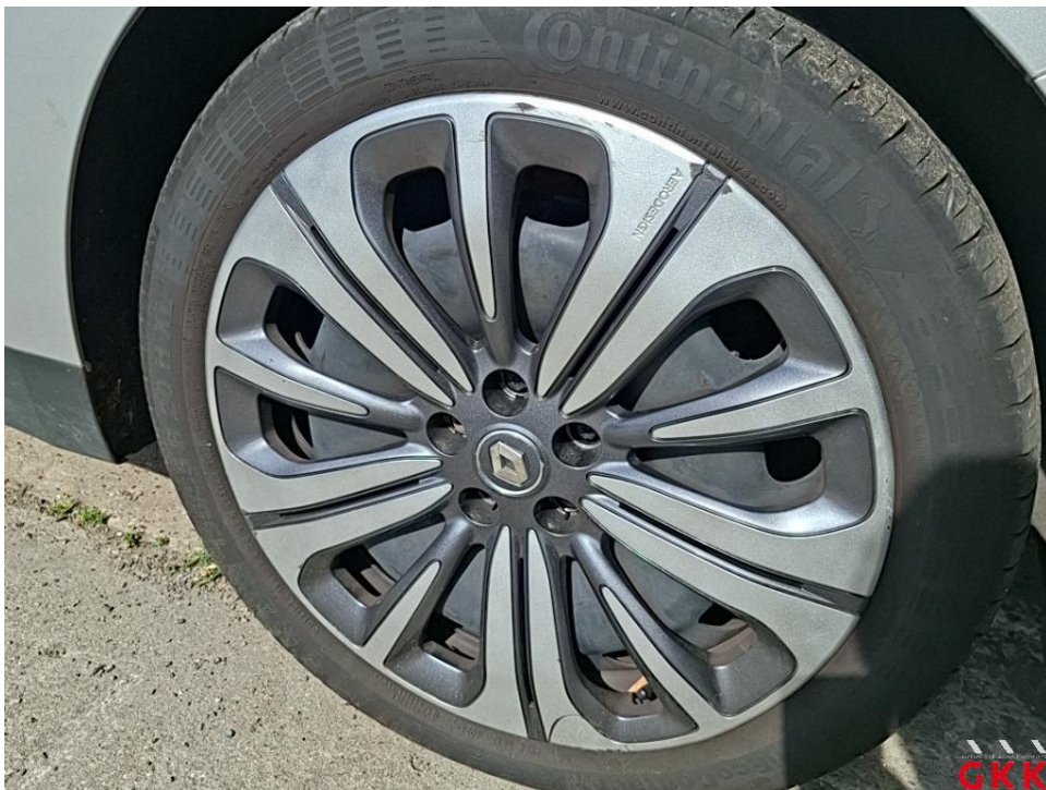
Bild 18. Radkappe(n), vorne rechts, verkratzt, ersetzen
