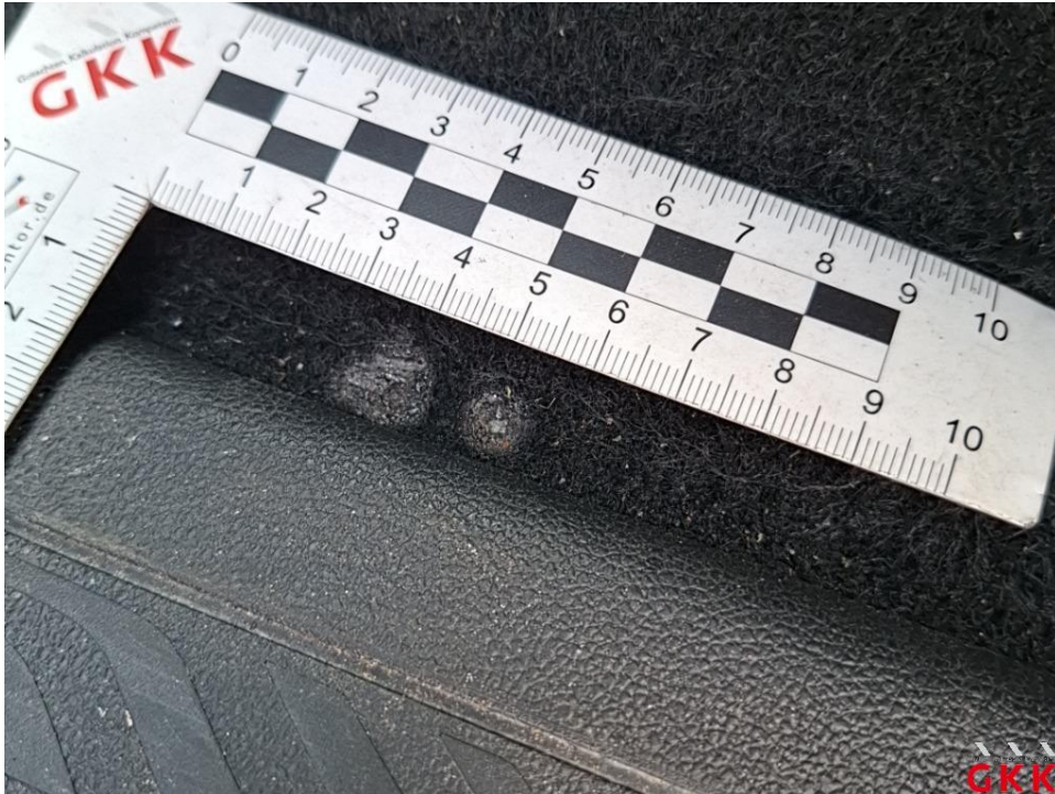
Bild 21. Teppich, vorne links, Brandloch, Smartrepair
