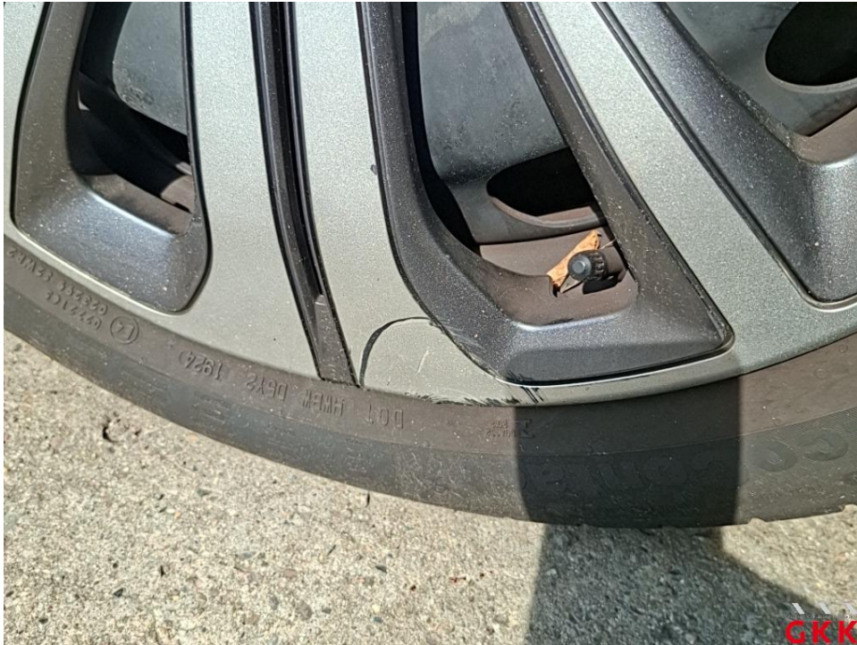
Bild 19. Radkappe(n), vorne rechts, verkratzt, ersetzen
