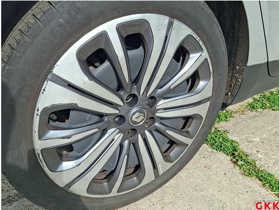
Bild 13. Radkappe(n), hinten rechts, verkratzt, ersetzen
