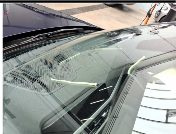
Beschädigung #7: Verglasung: Frontscheibe mit Spurhalteassistent - gebrochen / gerissen - erneuern
