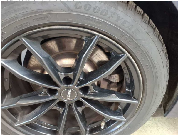
Beschädigung #5: Rad/Reifen: Leichtmetallfelge hinten rechts (Materialabtrag optisch zu hoch) - Kratzer - erneuern
