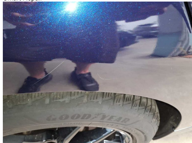
Beschädigung #2: Seitenwand rechts: Seitenwand - Kratzer - Smart Repair
