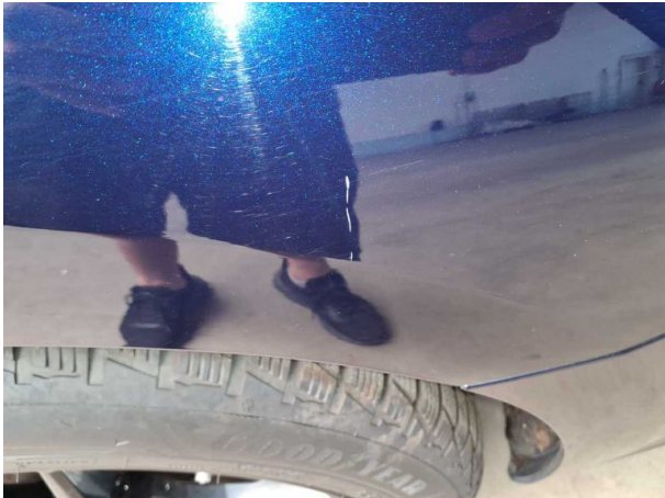
Beschädigung #1: Seitenwand links: Seitenwand - Kratzer - Smart Repair
