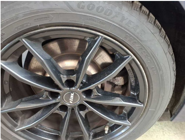
Damage #5: Wheel / tyres: Alloy rim - rear right side (Materialabtr... optisch zu hoch) - Scratch(es) - Replace
