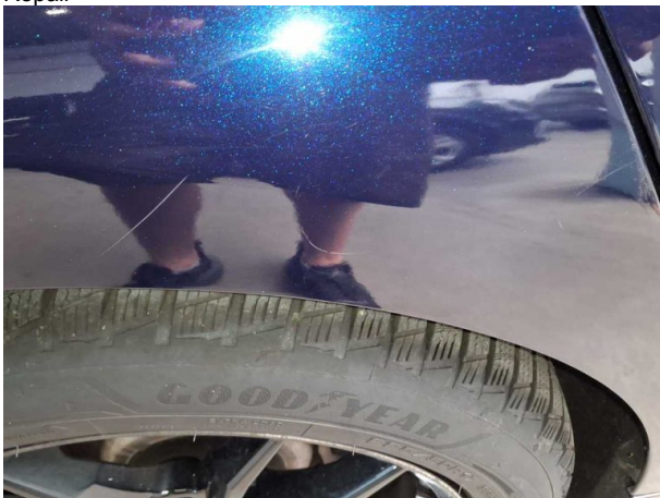
Beschädigung #2: Seitenwand rechts: Seitenwand - Kratzer - Smart Repair
