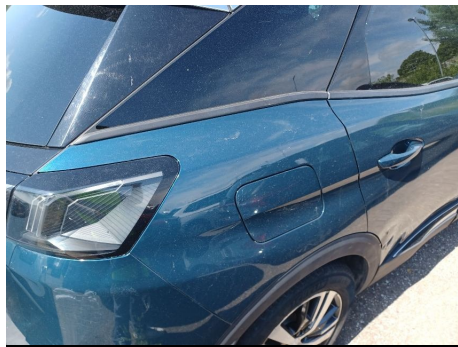
Parafango / Posteriore Destro / Rientranza
