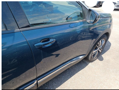
Porta / Anteriore Destro / Ammaccato vernice incisa
