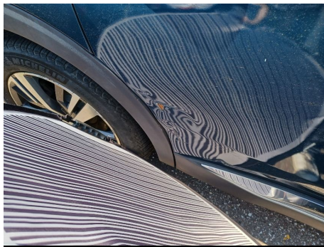
Porta / Posteriore Destro / Ammaccato vernice incisa
