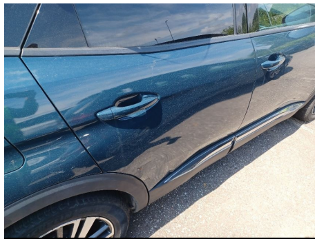
Porta / Posteriore Destro / Ammaccato vernice incisa
