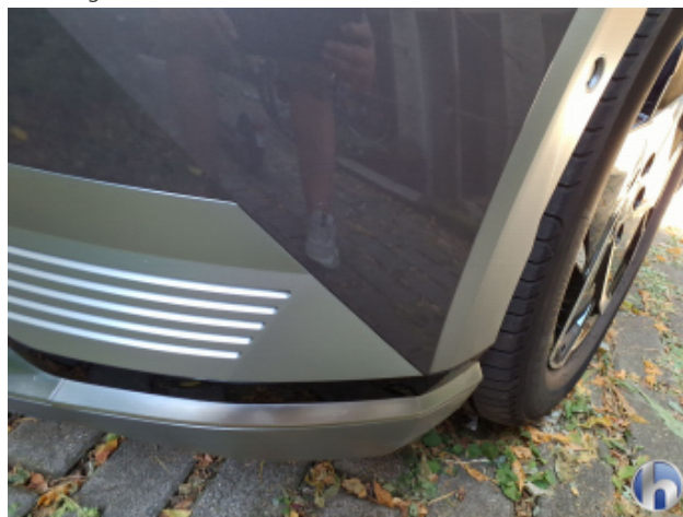
1. Stoßfänger Vorne Abschürfung - Lackieren
