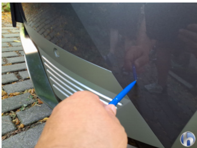
1. Stoßfänger Vorne Abschürfung - Lackieren
