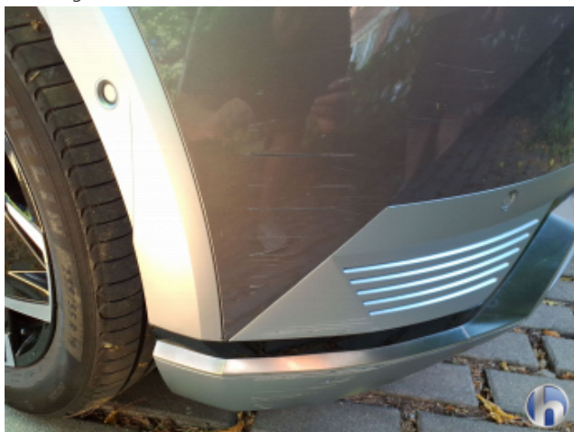
1. Stoßfänger Vorne Abschürfung - Lackieren
