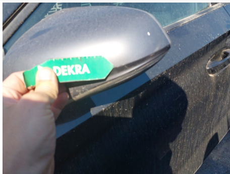
Carcasa del espejo de la puerta exterior / Izquierda / Rayado
