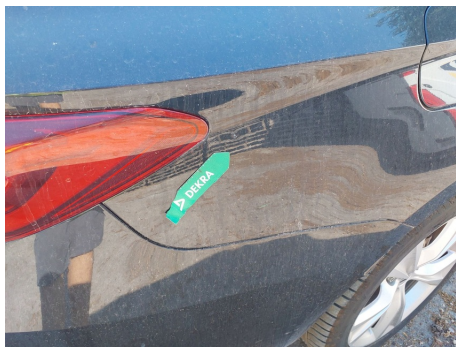
Aleta / Trasero Derecho / Abolladura
