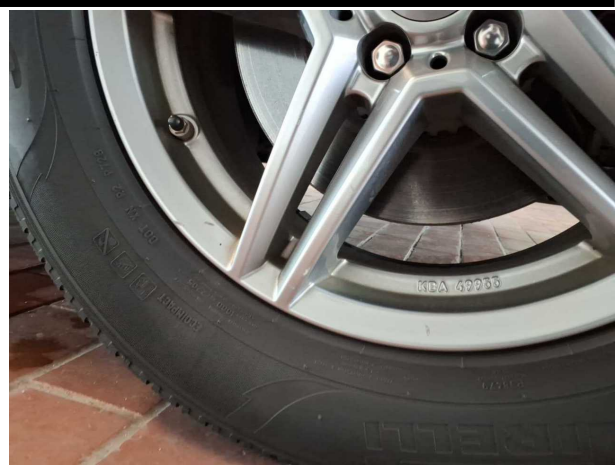
Beschädigung #3: 2.Radsatz: 1 Leichtmetallfelge - verkratzt / verschürft - Smart Repair
