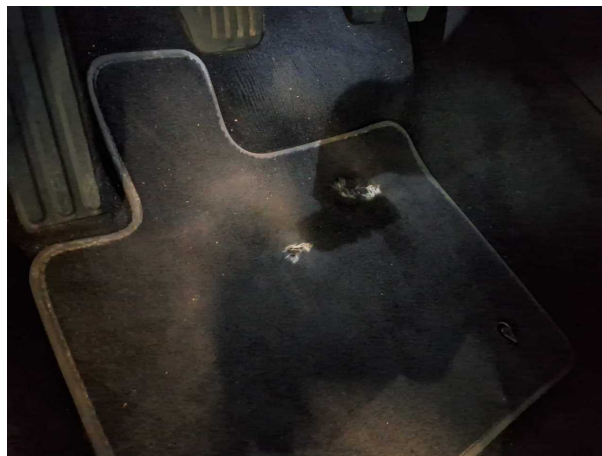
Beschädigung #1: Verkleidungen/Abdeckungen: Fußmatten (Vorne links) - beschädigt - erneuern
