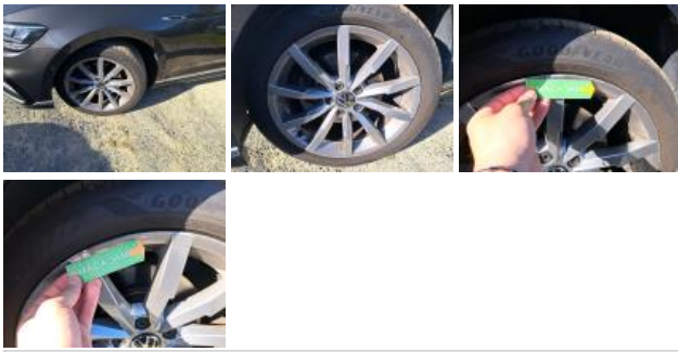
Alloy rim RL, Scratch(es), Repair/replace (lump sum)
