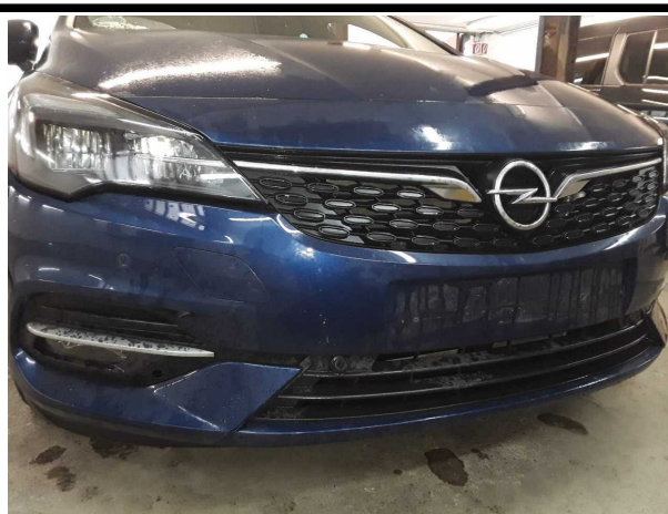
Beschädigung #4: Stossfänger vorn: Stossfänger vorn - Delle(n) - instandsetzen und lackieren
