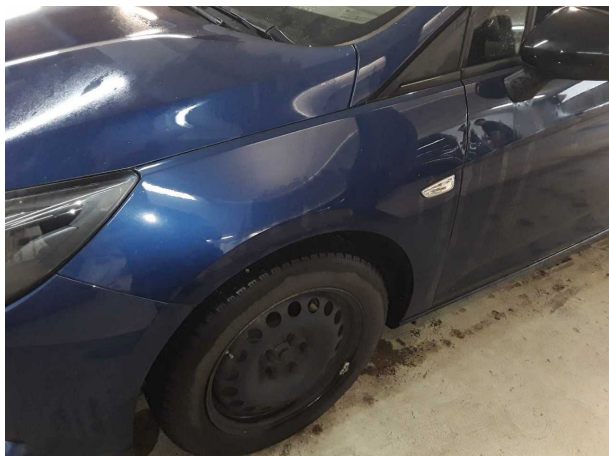
Beschädigung #1: Kotflügel links: Kotflügel links - verkratzt / verschürft - Smart Repair
