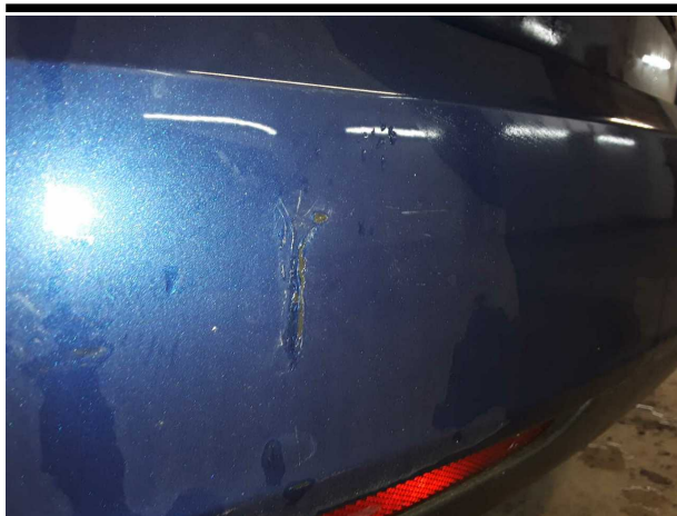
Beschädigung #3: Stossfänger hinten: Stossfänger hinten - verkratzt / verschürft - instandsetzen und lackieren
