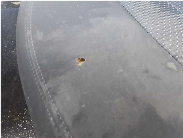
Beschädigung #8: Sitz vorn: Sitzbezug links - Brandloch - erneuern
