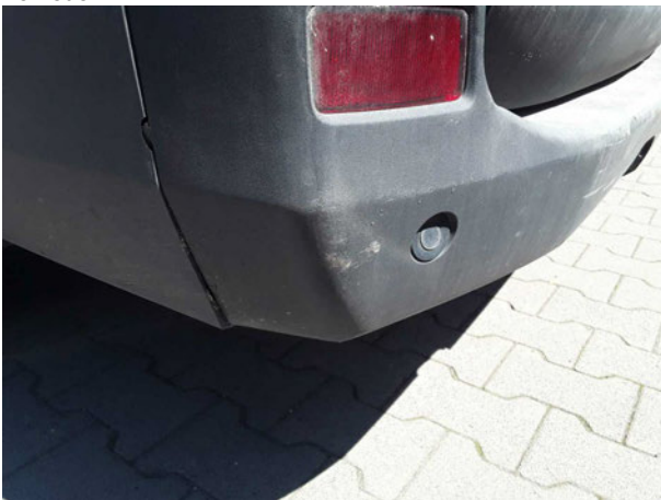
Beschädigung #9: Stossfänger hinten: Stossfänger hinten - beschädigt - erneuern
