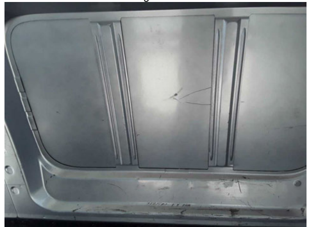
Beschädigung #5: Interieur: Laderaumunterteilung - Delle / Lackschaden - Wertminderung
