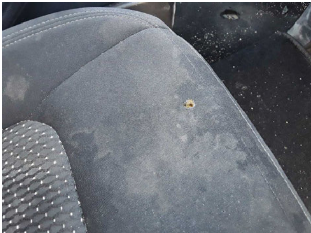
Beschädigung #10: Sitz vorn: Sitzbezug rechts - Brandloch - erneuern
