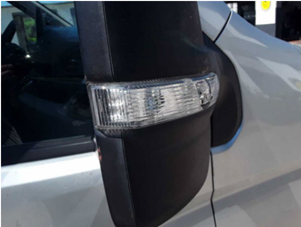
Beschädigung #4: Außenspiegel rechts: Spiegelgehäuse - beschädigt - erneuern
