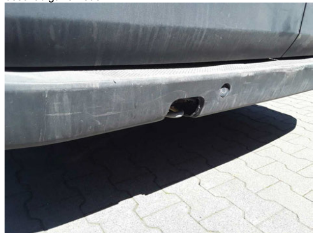
Beschädigung #9: Stossfänger hinten: Stossfänger hinten - beschädigt - erneuern
