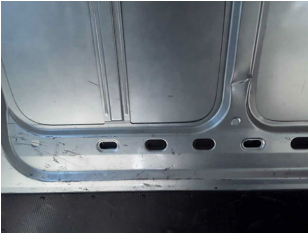
Beschädigung #5: Interieur: Laderaumunterteilung - Delle / Lackschaden - Wertminderung
