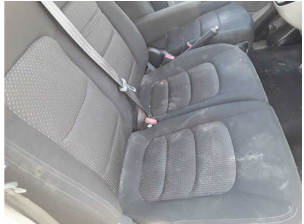
Beschädigung #10: Sitz vorn: Sitzbezug rechts - Brandloch - erneuern
