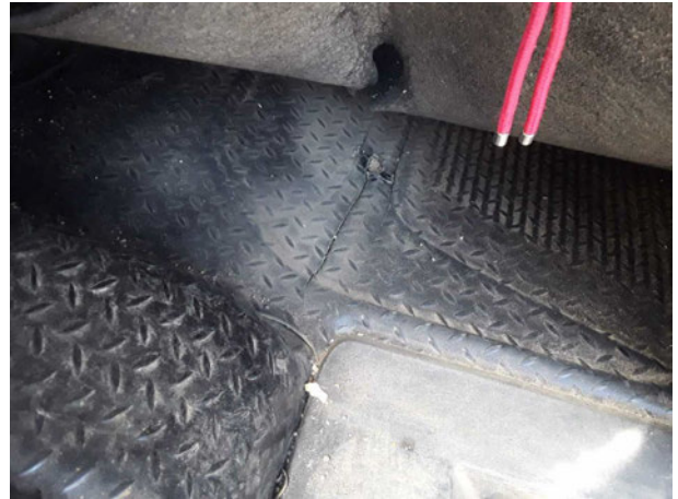
Beschädigung #6: Verkleidungen/Abdeckungen: Teppichboden vorn links - beschädigt - erneuern
