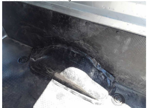
Beschädigung #5: Interieur: Laderaumunterteilung - Delle / Lackschaden - Wertminderung
