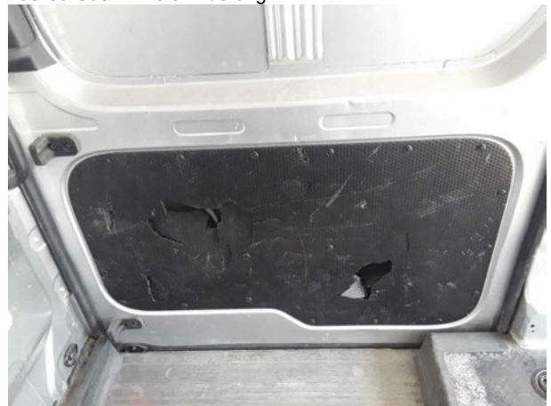
Beschädigung #5: Interieur: Laderaumunterteilung - Delle / Lackschaden - Wertminderung
