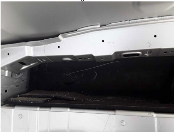
Beschädigung #5: Interieur: Laderaumunterteilung - Delle / Lackschaden - Wertminderung
