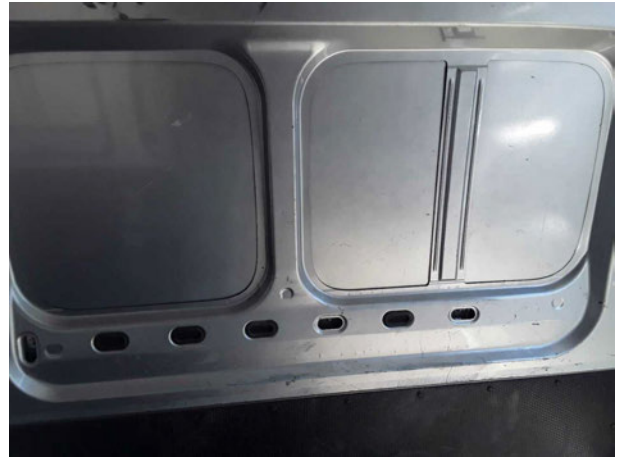
Beschädigung #5: Interieur: Laderaumunterteilung - Delle / Lackschaden - Wertminderung
