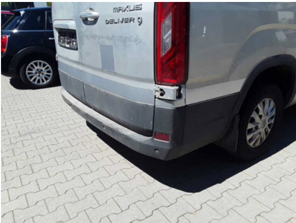
Beschädigung #9: Stossfänger hinten: Stossfänger hinten - beschädigt - erneuern
