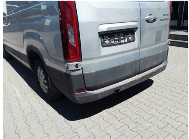
Beschädigung #9: Stossfänger hinten: Stossfänger hinten - beschädigt - erneuern
