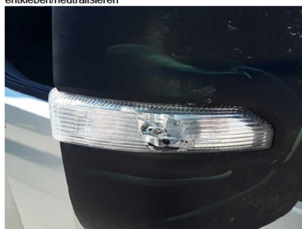
Beschädigung #4: Außenspiegel rechts: Spiegelgehäuse - beschädigt - erneuern
