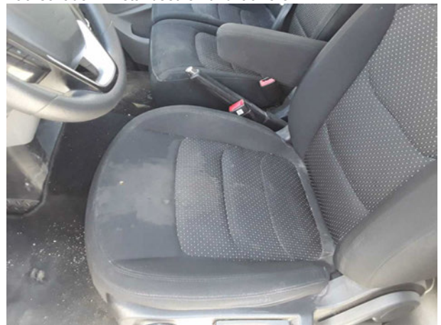
Beschädigung #8: Sitz vorn: Sitzbezug links - Brandloch - erneuern
