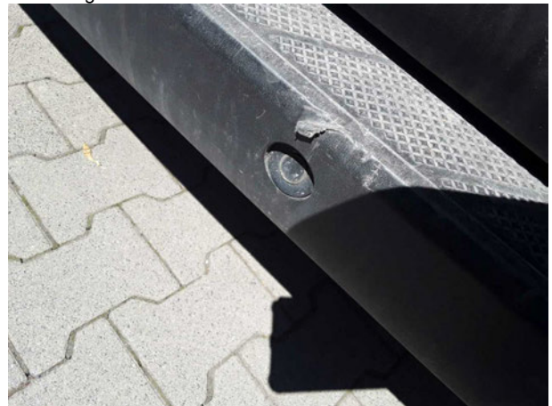
Beschädigung #9: Stossfänger hinten: Stossfänger hinten - beschädigt - erneuern
