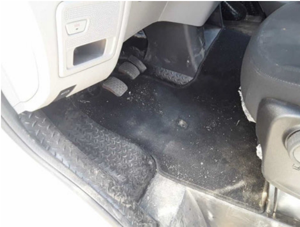
Beschädigung #6: Verkleidungen/Abdeckungen: Teppichboden vorn links - beschädigt - erneuern
