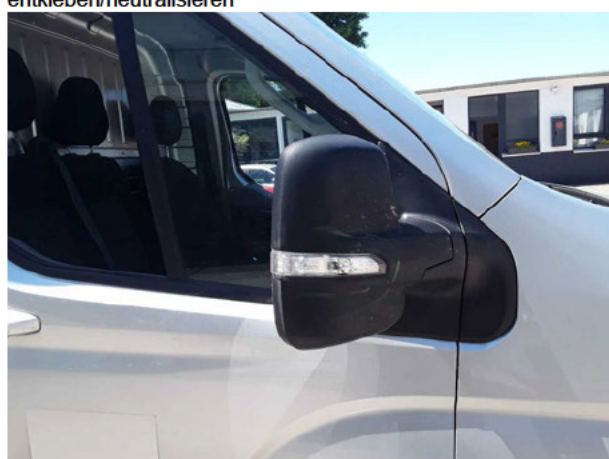
Beschädigung #4: Außenspiegel rechts: Spiegelgehäuse - beschädigt - erneuern
