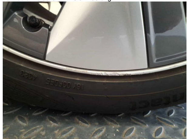
Beschädigung #7: Rad/Reifen: Leichtmetallfelge vorn rechts - verkratzt / verschürft - Wertminderung
