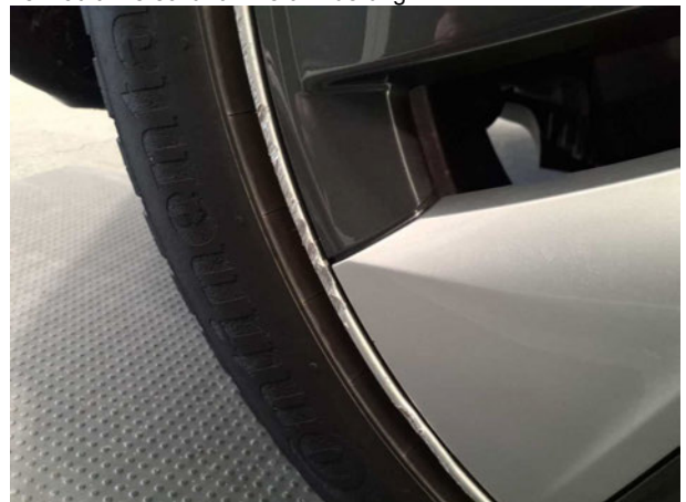
Beschädigung #5: Rad/Reifen: Leichtmetallfelge hinten rechts - verkratzt / verschürft - Wertminderung
