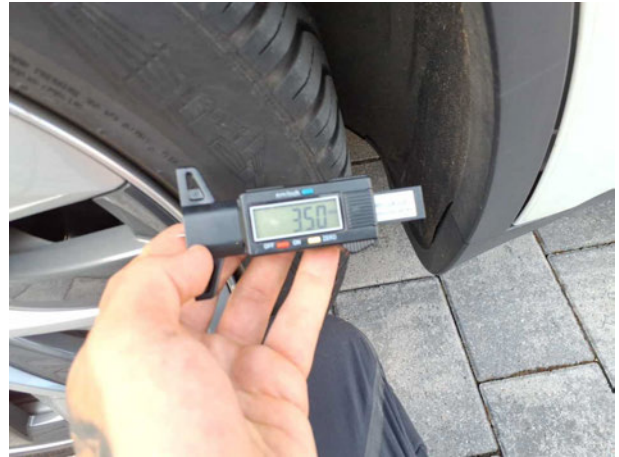
Beschädigung #8: Rad/Reifen: Reifen hinten - verschlissen - erneuern
