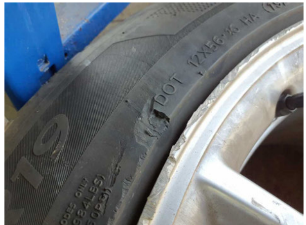
Beschädigung #7: 2.Radsatz: 3 Reifen - beschädigt - erneuern
