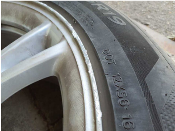
Beschädigung #11: 2.Radsatz: 3 Leichtmetallfelgen - beschädigt - erneuern
