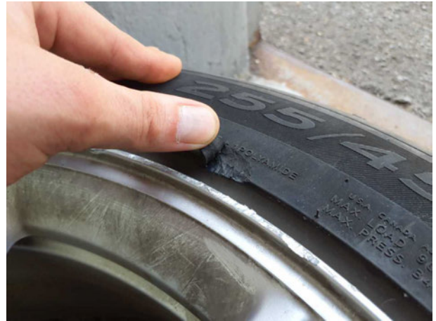
Beschädigung #7: 2.Radsatz: 3 Reifen - beschädigt - erneuern
