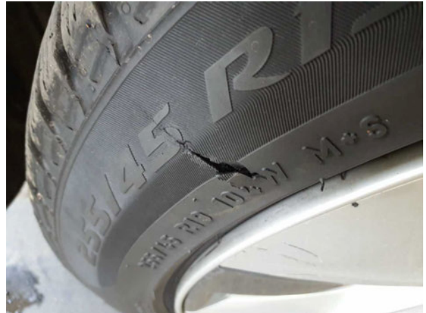
Beschädigung #5: Rad/Reifen: Reifen hinten rechts - beschädigt - erneuern
