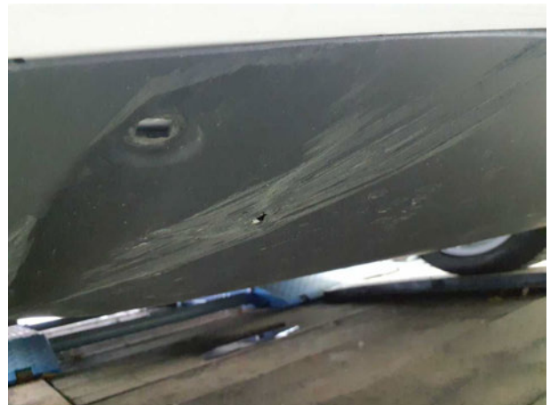
Beschädigung #6: Karosserie: Unterbodenverkleidung - beschädigt - erneuern
