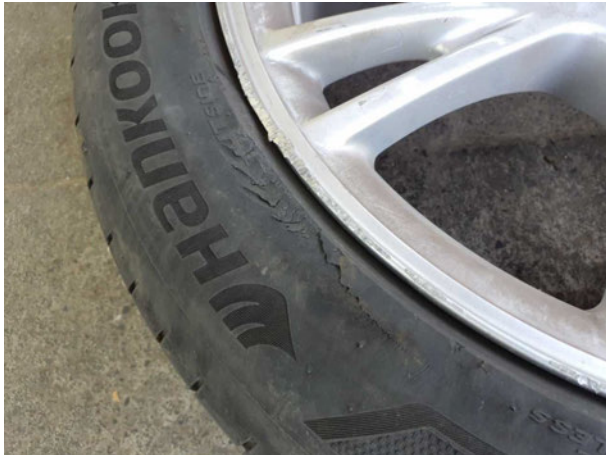
Beschädigung #7: 2.Radsatz: 3 Reifen - beschädigt - erneuern
