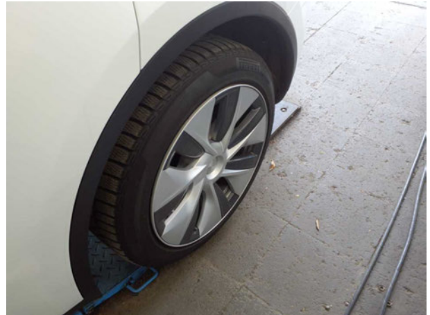
Beschädigung #8: Rad/Reifen: Leichtmetallfelge hinten links - nicht fachgerecht instandgesetzt - erneuern
