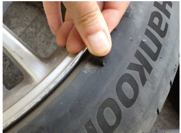
Beschädigung #7: 2.Radsatz: 3 Reifen - beschädigt - erneuern
