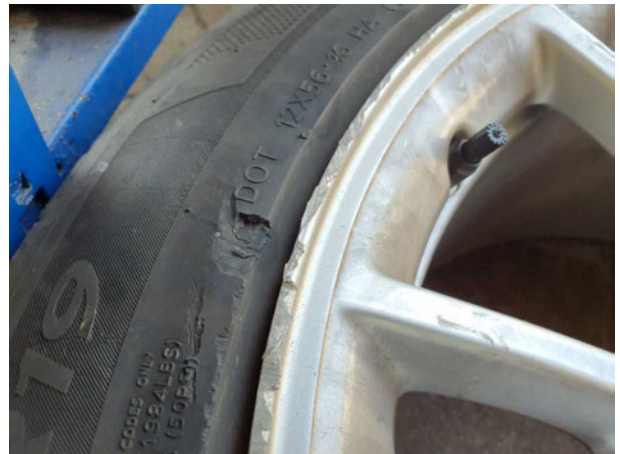
Beschädigung #11: 2.Radsatz: 3 Leichtmetallfelgen - beschädigt - erneuern
