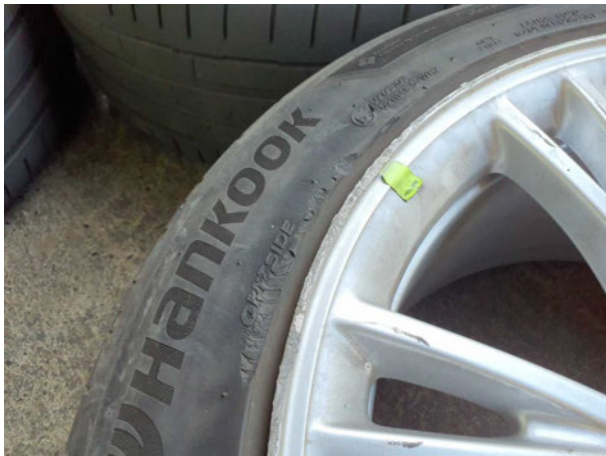
Beschädigung #7: 2.Radsatz: 3 Reifen - beschädigt - erneuern
