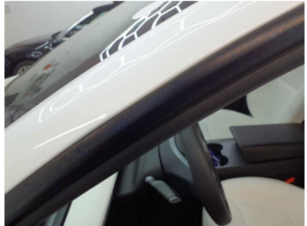
Beschädigung #4: Tür vorn links: Schachtleiste außen (Rundum) - Lackmangel - Wertminderung
