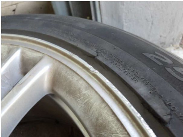
Beschädigung #11: 2.Radsatz: 3 Leichtmetallfelgen - beschädigt - erneuern
