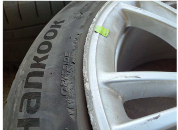
Beschädigung #11: 2.Radsatz: 3 Leichtmetallfelgen - beschädigt - erneuern
