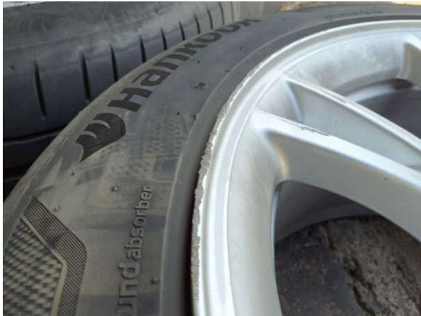
Beschädigung #11: 2.Radsatz: 3 Leichtmetallfelgen - beschädigt - erneuern
