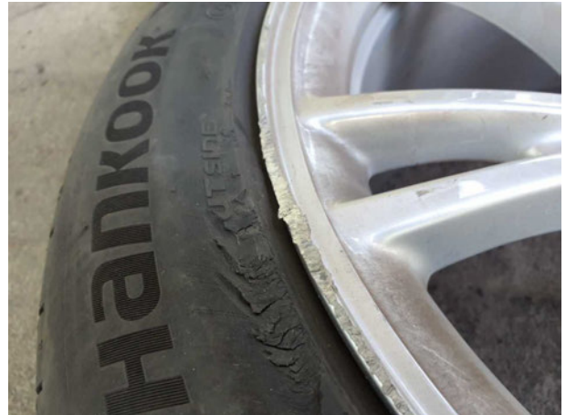
Beschädigung #11: 2.Radsatz: 3 Leichtmetallfelgen - beschädigt - erneuern
