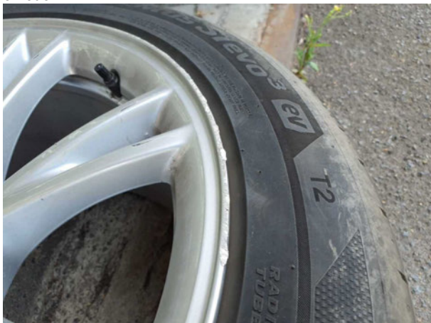
Beschädigung #11: 2.Radsatz: 3 Leichtmetallfelgen - beschädigt - erneuern
