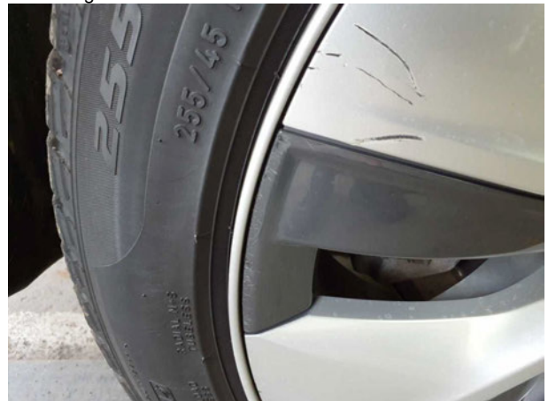
Beschädigung #1: Rad/Reifen: Radblende hinten rechts - beschädigt - erneuern
