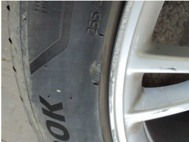
Beschädigung #7: 2.Radsatz: 3 Reifen - beschädigt - erneuern
