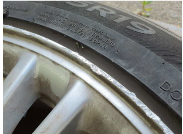
Beschädigung #11: 2.Radsatz: 3 Leichtmetallfelgen - beschädigt - erneuern
