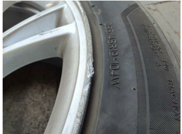
Beschädigung #11: 2.Radsatz: 3 Leichtmetallfelgen - beschädigt - erneuern
