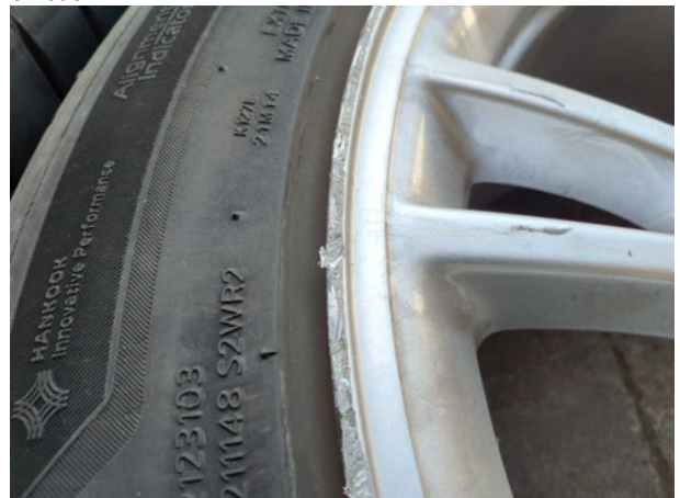
Beschädigung #11: 2.Radsatz: 3 Leichtmetallfelgen - beschädigt - erneuern
