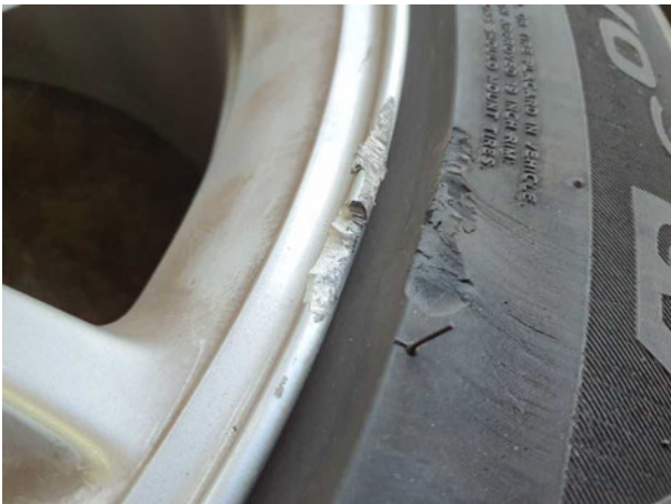
Beschädigung #11: 2.Radsatz: 3 Leichtmetallfelgen - beschädigt - erneuern
