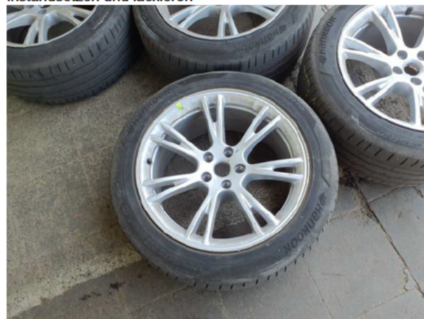
Beschädigung #11: 2.Radsatz: 3 Leichtmetallfelgen - beschädigt - erneuern
