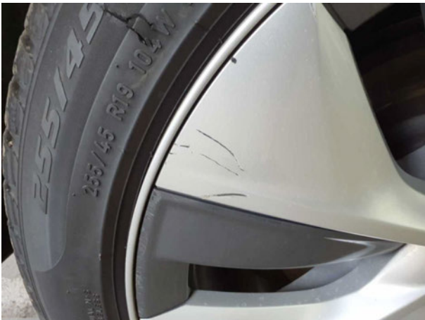
Beschädigung #1: Rad/Reifen: Radblende hinten rechts - beschädigt - erneuern
