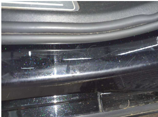
Beschädigung #1: Seitenwand links: Einstieg - Kratzer - Smart Repair
