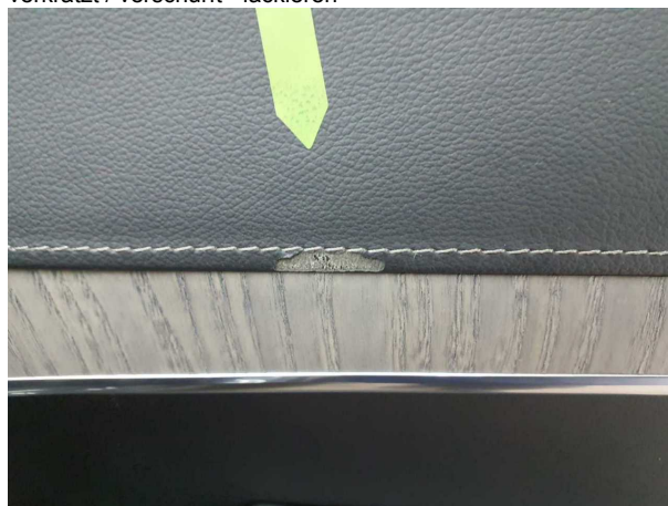
Beschädigung #8: Verkleidungen/Abdeckungen: Türverkleidung hinten rechts - beschädigt - erneuern
