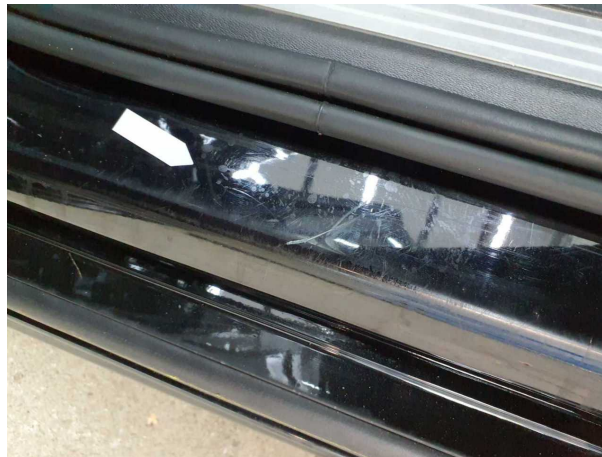
Beschädigung #1: Seitenwand links: Einstieg - Kratzer - Smart Repair
