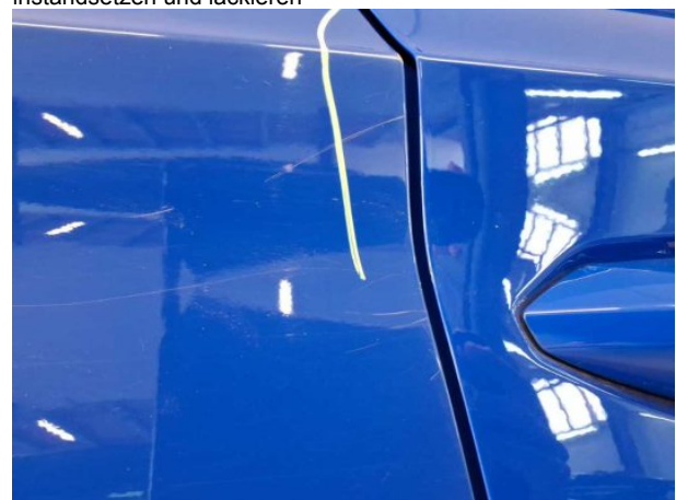
Beschädigung #13: Tür hinten rechts: Tür - Kratzer - instandsetzen und lackieren
