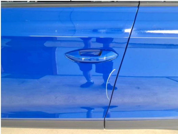
Beschädigung #8: Tür vorn links: Griff außen - verkratzt / verschürft - Smart Repair
