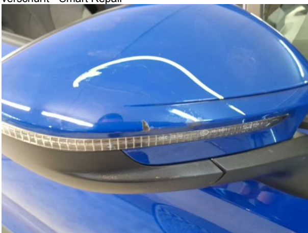
Beschädigung #9: Außenspiegel rechts: Abdeckkappe - verkratzt / verschürft - Smart Repair
