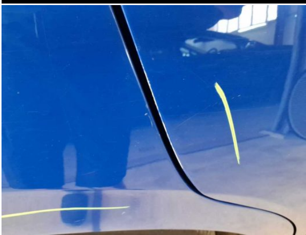
Beschädigung #13: Tür hinten rechts: Tür - Kratzer - instandsetz... und lackieren
