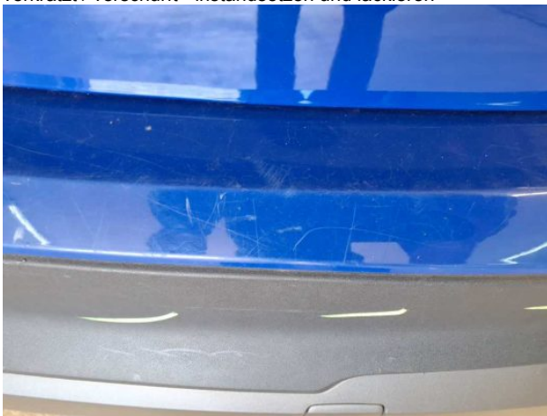
Beschädigung #12: Stossfänger hinten: Stossfänger hinten - verkratzt / verschürft - instandsetzen und lackieren
