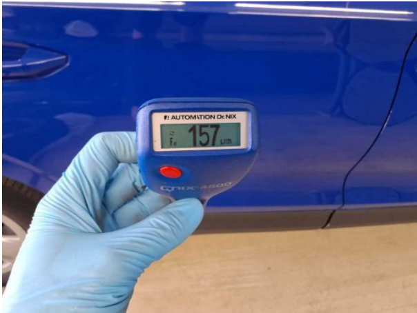
Nachlackierung 1: Seitenwand rechts, Tür hinten rechts
