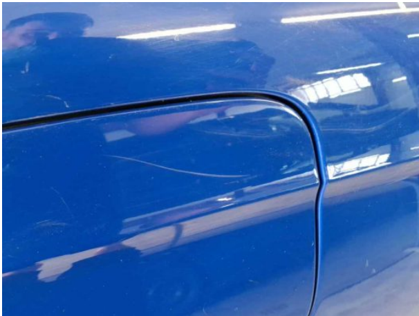
Beschädigung #14: Seitenwand rechts: Seitenwand - Kratzer - instandsetzen und lackieren
