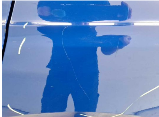
Beschädigung #2: Seitenwand links: Seitenwand - Kratzer - auslegen / polieren
