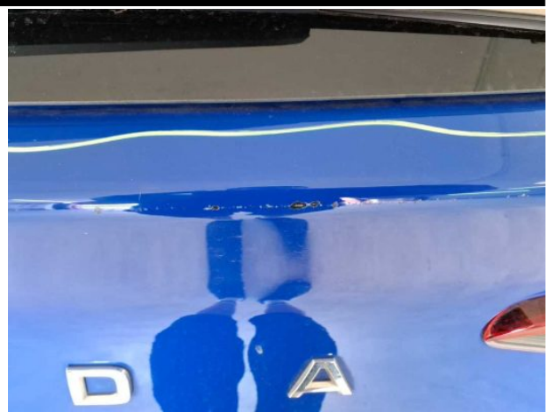
Beschädigung #15: Heckklappe/-tür: Heckklappe - verkratzt / verschürft - instandsetzen und lackieren
