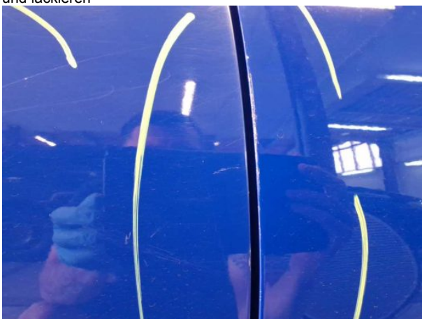
Beschädigung #13: Tür hinten rechts: Tür - Kratzer - instandsetz... und lackieren
