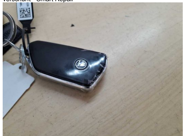
Beschädigung #11: Ausrüstung: Fahrzeugschlüssel m. Fernb. - beschädigt - erneuern
