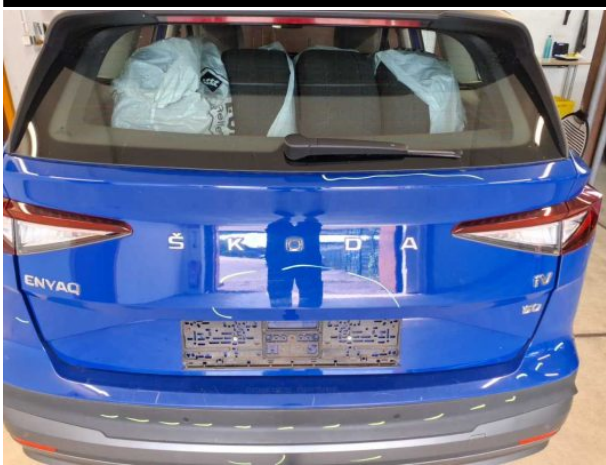
Beschädigung #15: Heckklappe/-tür: Heckklappe - verkratzt / verschürft - instandsetzen und lackieren
