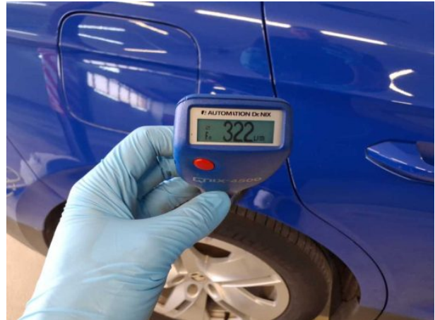
Nachlackierung 1: Seitenwand rechts, Tür hinten rechts
