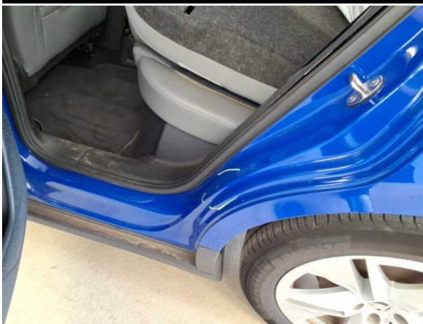
Beschädigung #7: Seitenwand links: Einstieg - Delle / Lackschaden - Smart Repair
