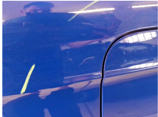
Beschädigung #14: Seitenwand rechts: Seitenwand - Kratze... instandsetzen und lackieren
