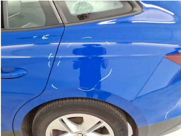
Beschädigung #2: Seitenwand links: Seitenwand - Kratzer - auslegen / polieren
