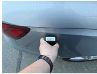
Lackstärke Seitenwand hinten rechts
