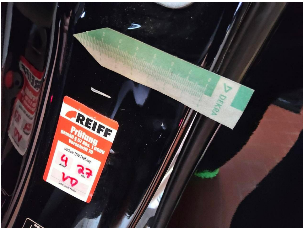
Bild 14 : Einstiegsschweller vorne links verschrammt und eingedellt
