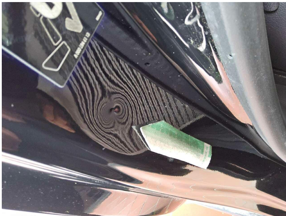
Bild 23 : Einstiegsschweller hinten rechts eingedellt
