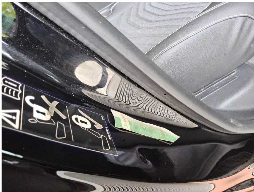
Bild 25 : Einstiegsschweller hinten rechts eingedellt
