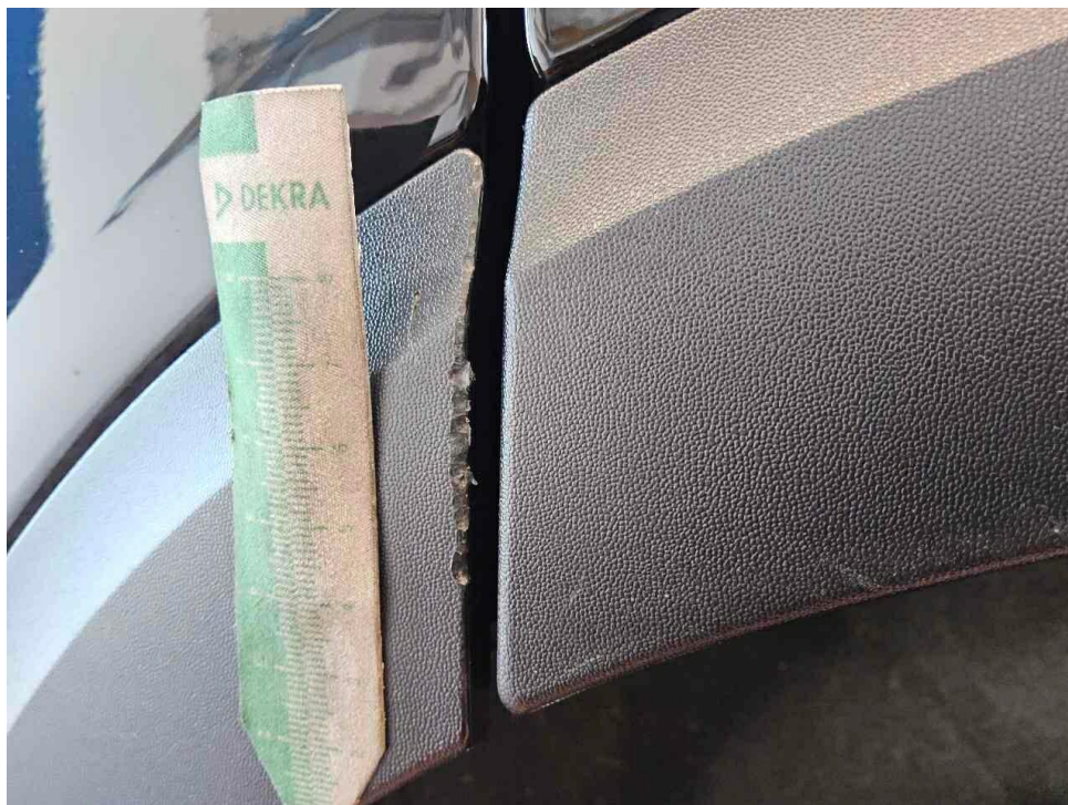
Bild 44 : Türzierleiste hinten links oben verschrammt
