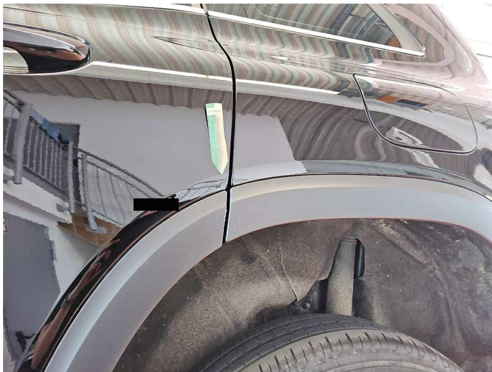
Bild 43 : Türzierleiste hinten links oben verschrammt
