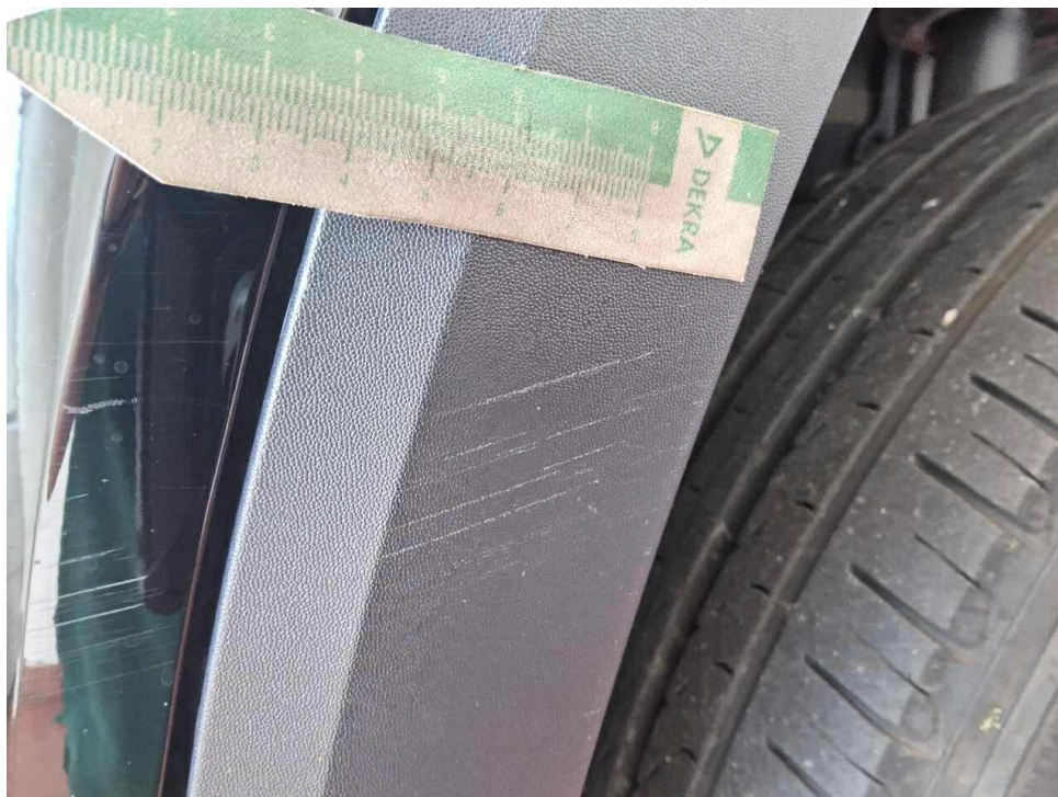
Bild 38 : Radlaufzierblende vorne links verschrammt
