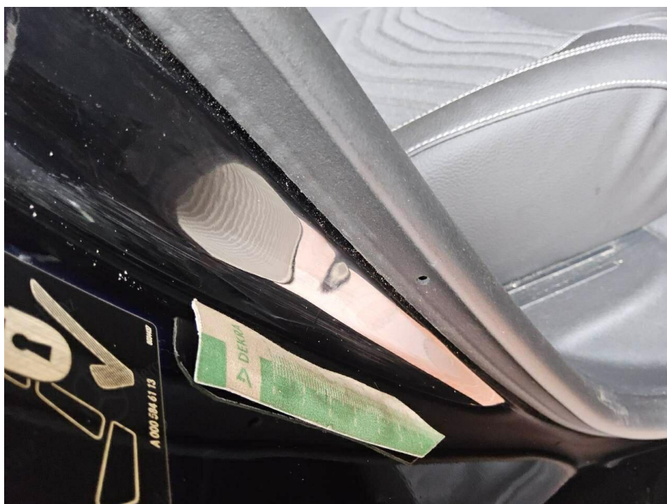
Bild 24 : Einstiegsschweller hinten rechts eingedellt
