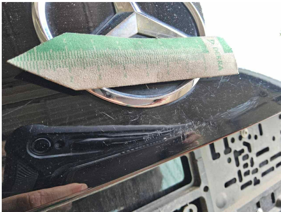
Bild 27 : Heckklappe oberhalb verschrammt
