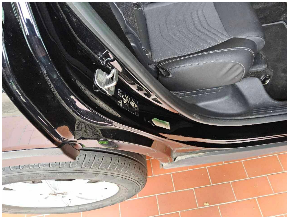
Bild 21 : Einstiegsschweller hinten rechts eingedellt
