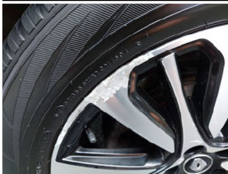
Felge / Hinten Rechts / Rost
