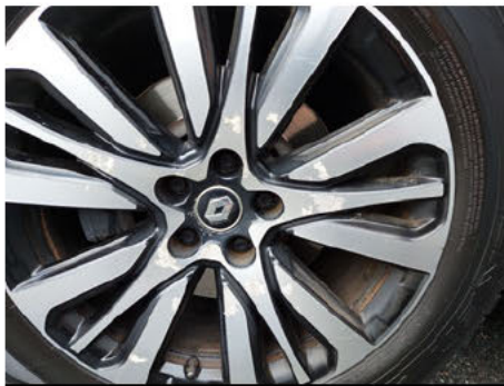
Felge / Vorne Links / Rost
