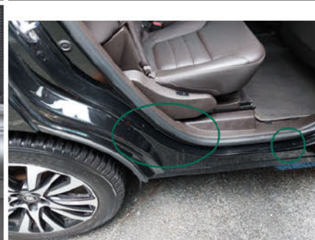
Türeinstieg / Hinten Rechts / Kratzer
