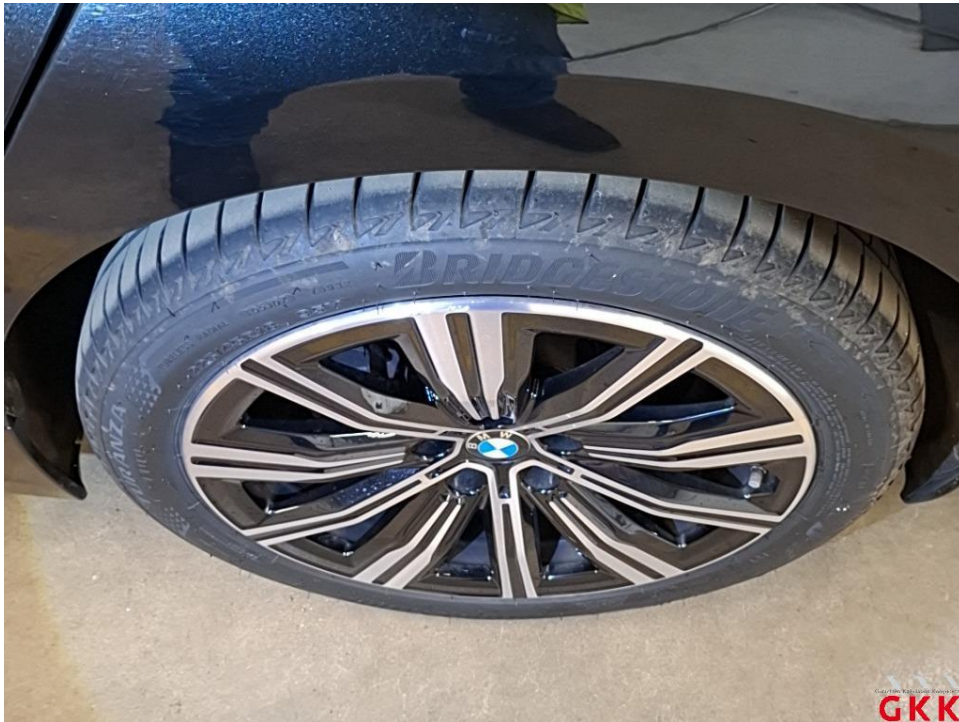
Bild 32 LM-Rad, hinten links, beschädigt, ersetzen
