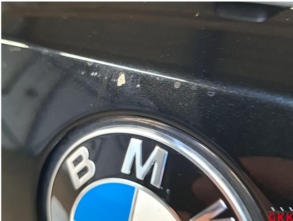
Bild 40 Heckklappe, unterhalb, verkratzt, lackieren
