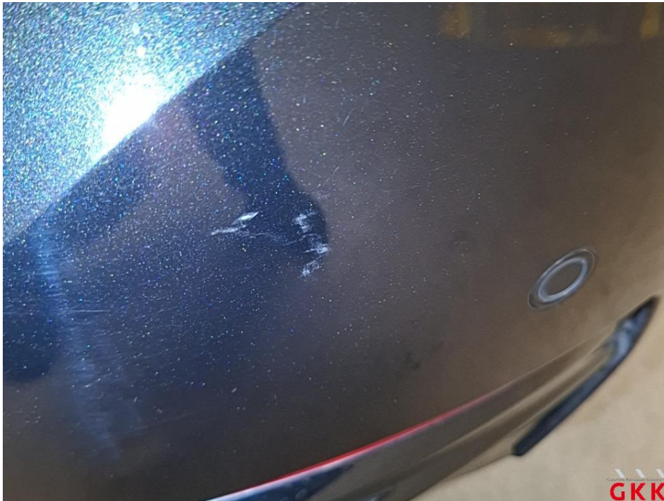
Bild 35 Stoßfänger hinten, Verkleidung -lackiert-, verkratzt, lackieren
