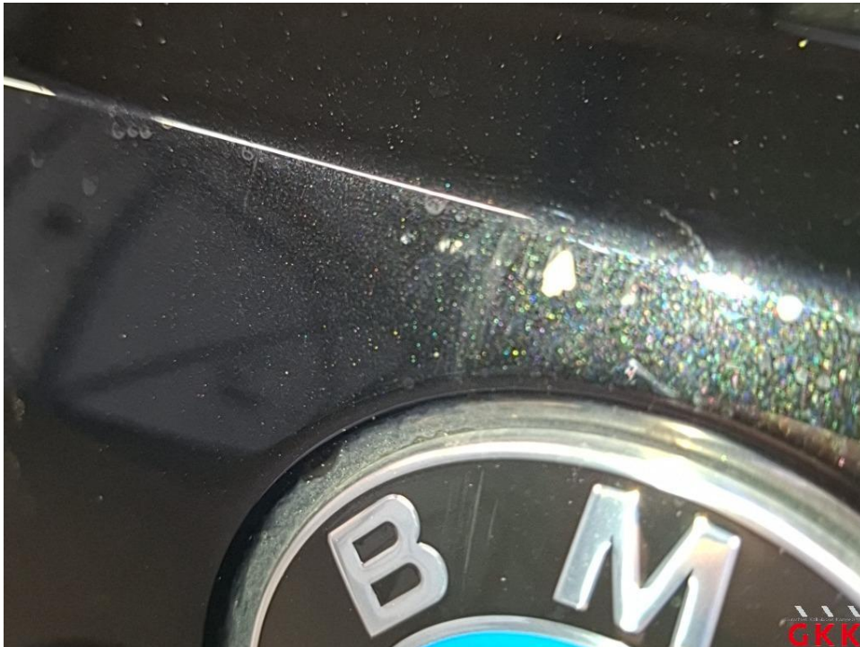
Bild 41 Heckklappe, unterhalb, verkratzt, lackieren
