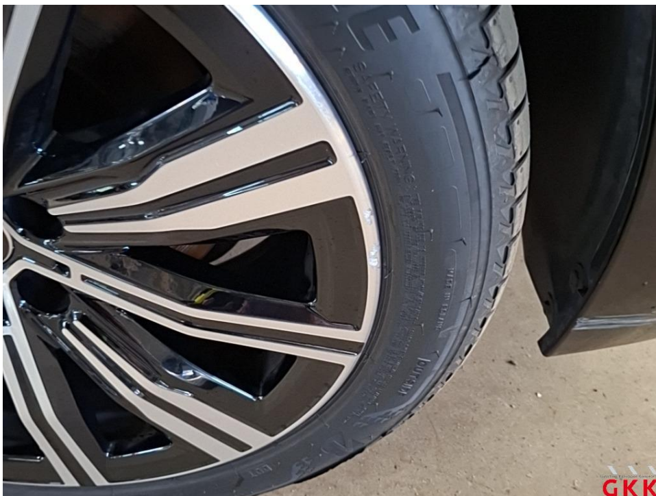
Bild 21 LM-Rad, vorne rechts, Materialabtrag, ersetzen
