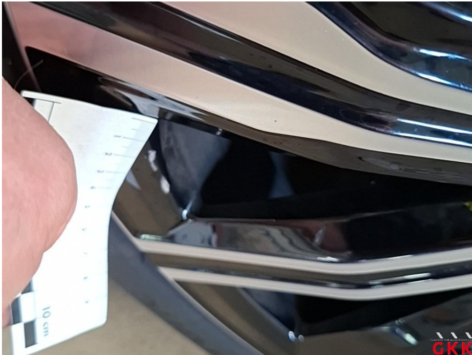
Bild 23 LM-Rad, vorne rechts, Materialabtrag, ersetzen
