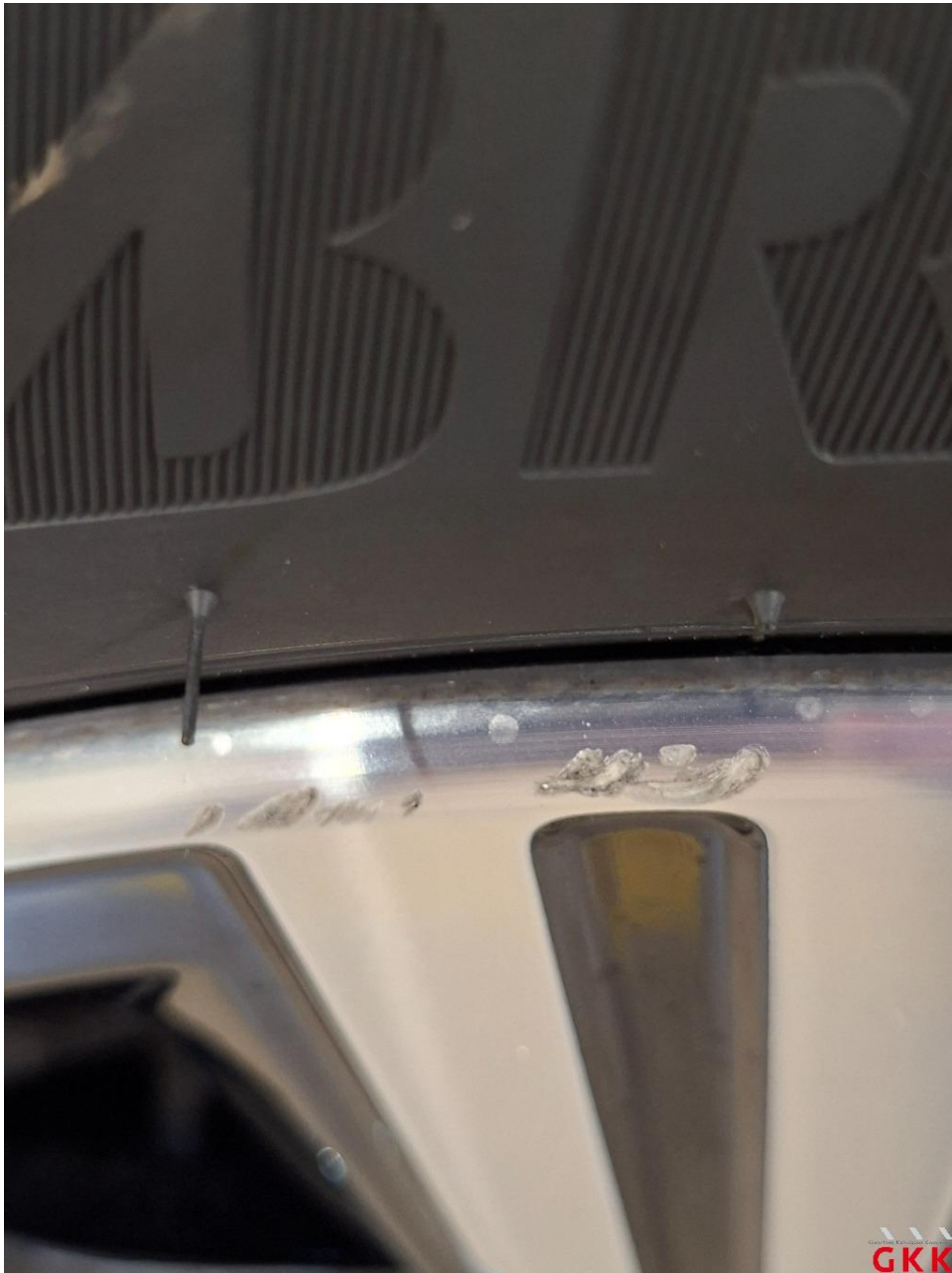
Bild 34 LM-Rad, hinten links, beschädigt, ersetzen
