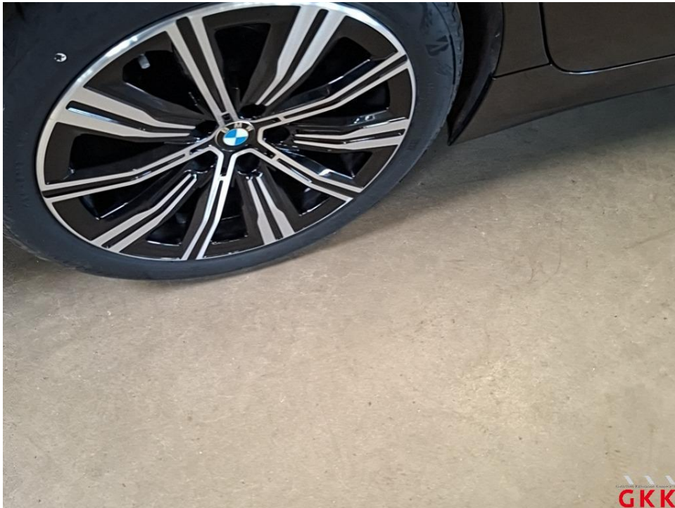
Bild 37 LM-Rad, hinten rechts, Materialabtrag, ersetzen
