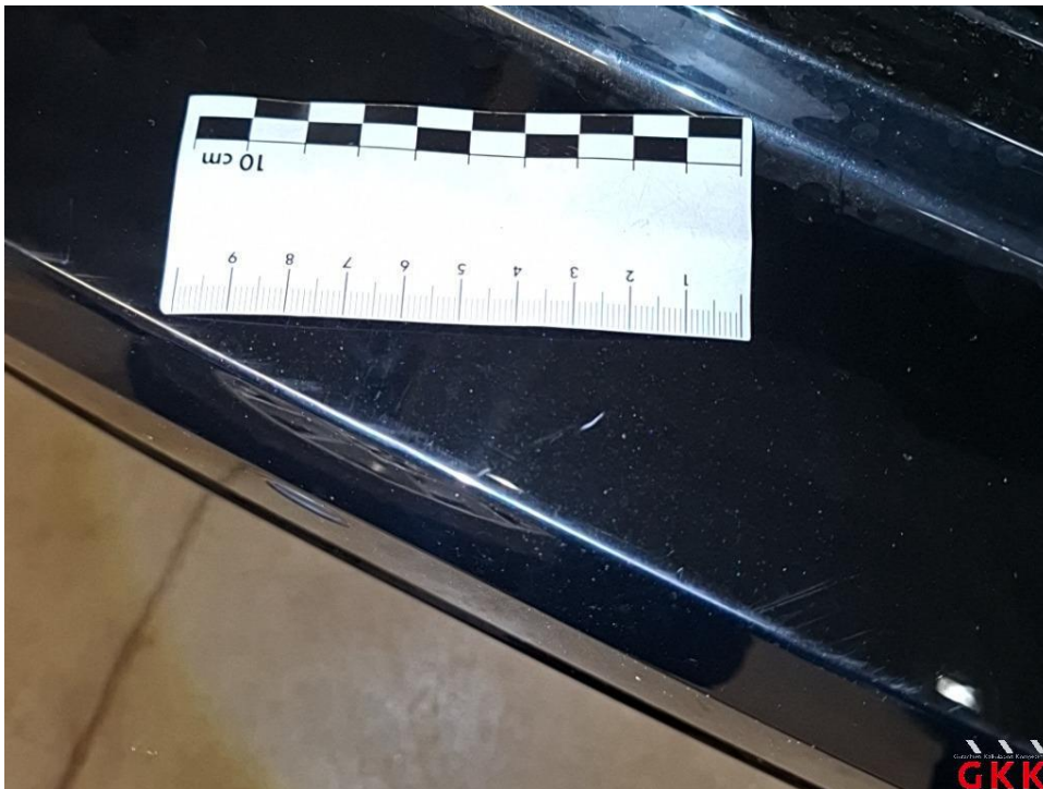
Bild 36 Stoßfänger hinten, Verkleidung -lackiert-, verkratzt, lackieren
