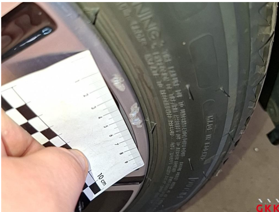
Bild 22 LM-Rad, vorne rechts, Materialabtrag, ersetzen
