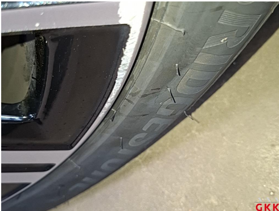
Bild 38 LM-Rad, hinten rechts, Materialabtrag, ersetzen
