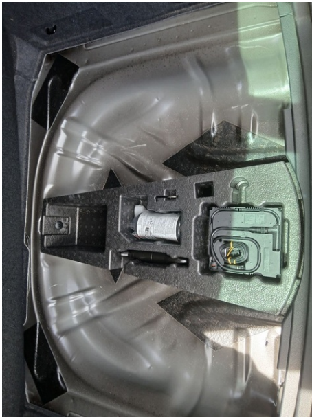
Elementos faltantes / Kit de reparación de neumáticos compresor
