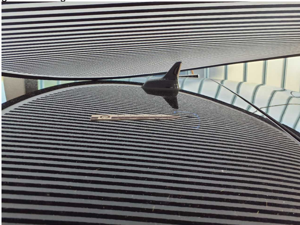
Beschädigung #2: Fahrzeugdach: Dach - Delle(n) - sanft instandsetzen
