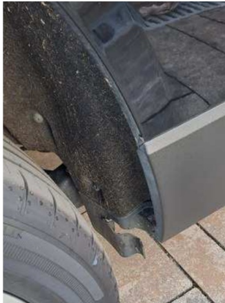
Beschädigung #1: Karosserie: Radhaus hinten rechts - gebrochen / gerissen - erneuern
