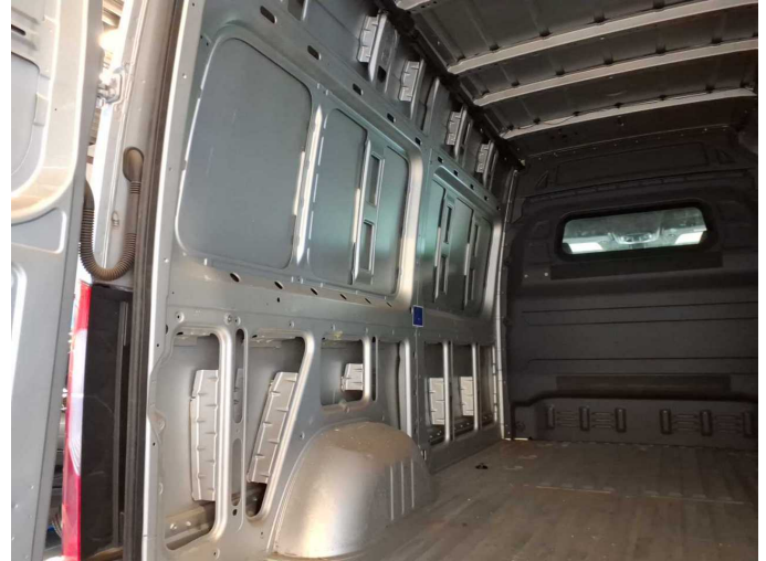
Damage 5: Trim / covers: Boot lining (Unterteile fehlen komplett) - Missing - Replace
