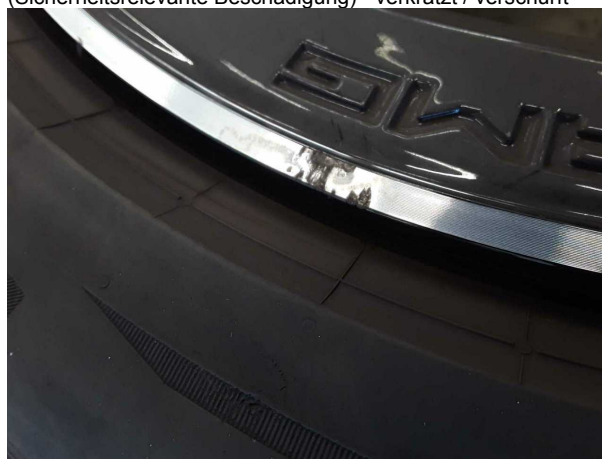
Beschädigung #5: 2.Radsatz: 1 Leichtmetallfelge - verkratzt / verschürft - erneuern
