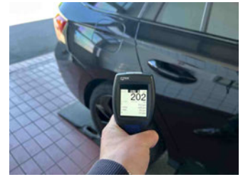
Lackstärke Seitenwand hinten rechts
