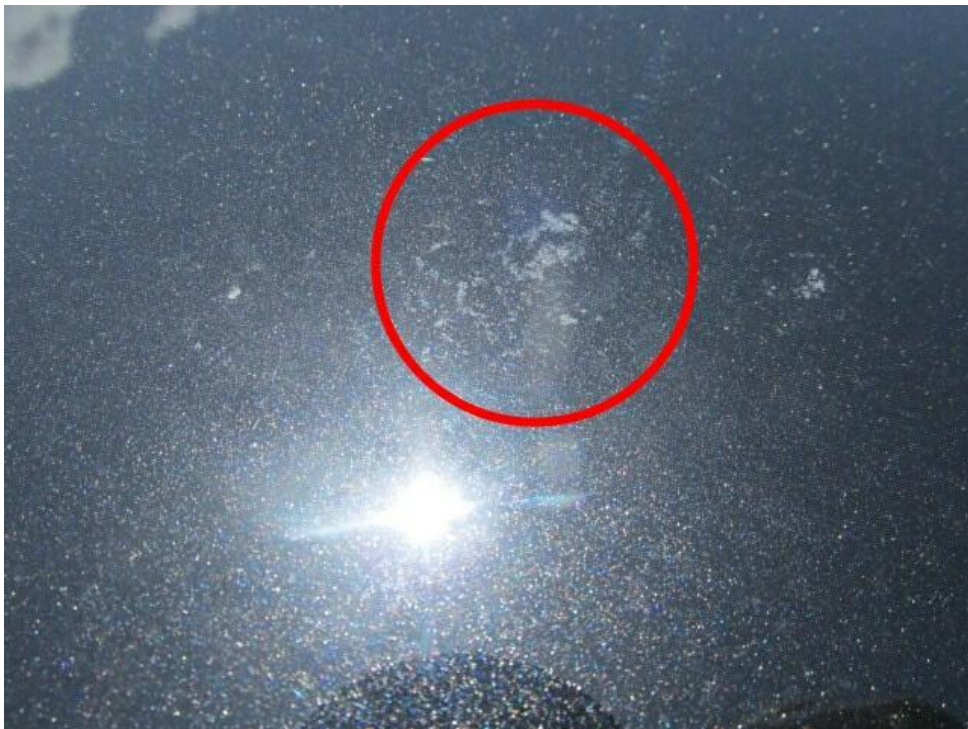
Bild 14 : Motorhaube erhebliche Lackanätzungen
