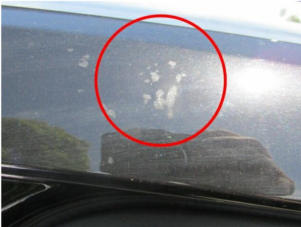
Bild 19 : Dachholm rechts Lackanätzungen ( Schaden ausweitungen möglich).
