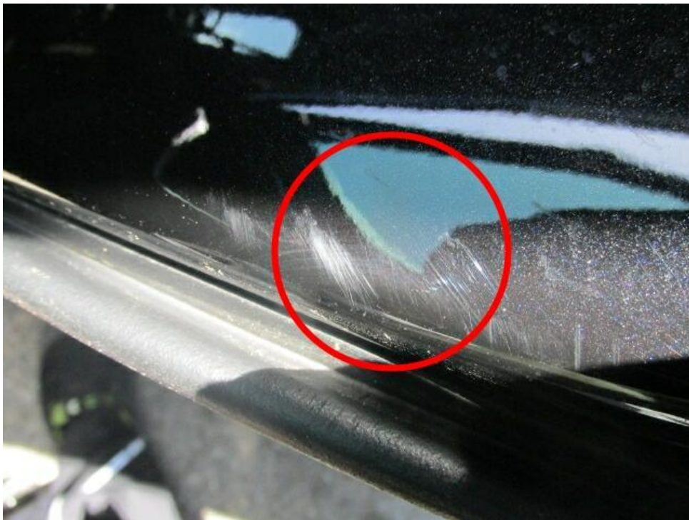
Bild 20 : Einstieg hinten links Kratzer
