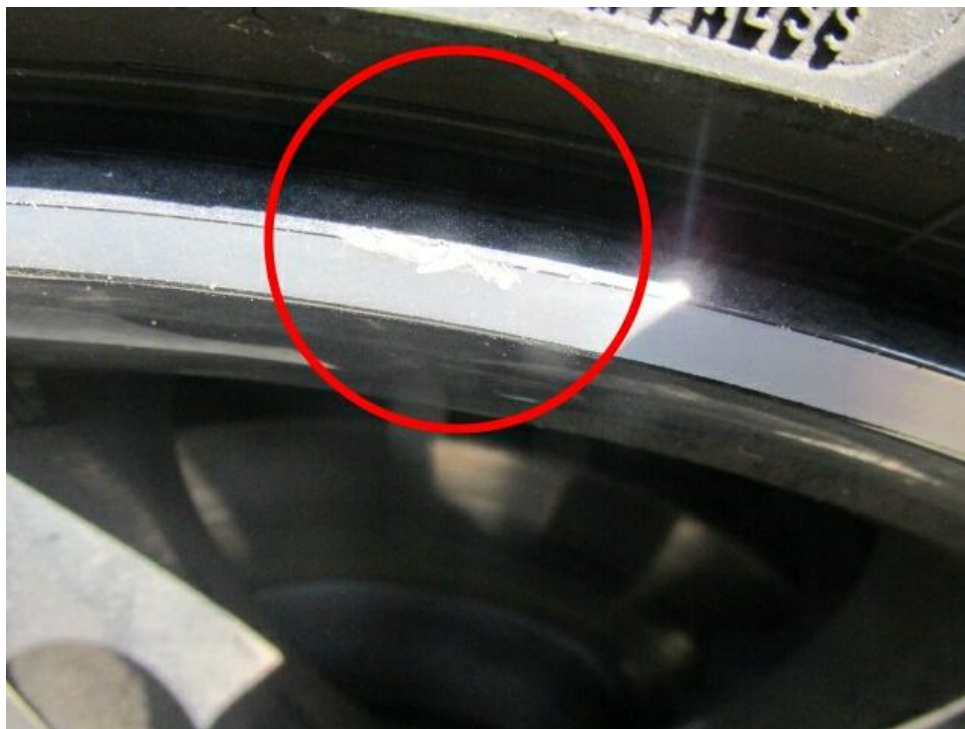
Bild 17 : Felge vorne rechts verschrammt ( glanzgedreht).
