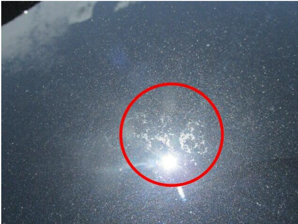
Bild 13 : Motorhaube erhebliche Lackanätzungen
