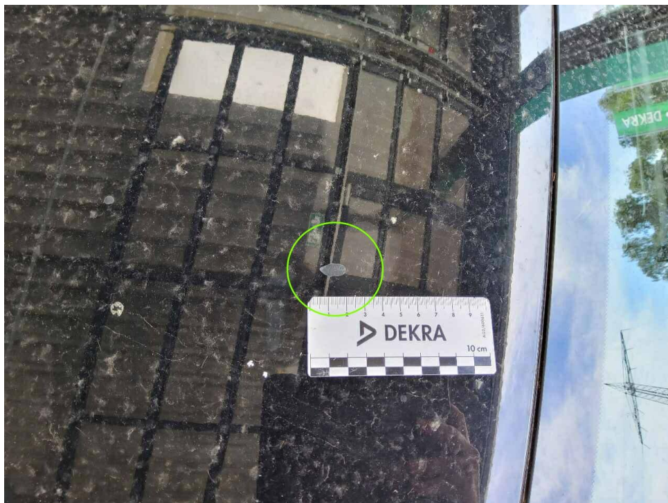
Bild 26 : Lackierung Dach Baumharzreste reinigen und
