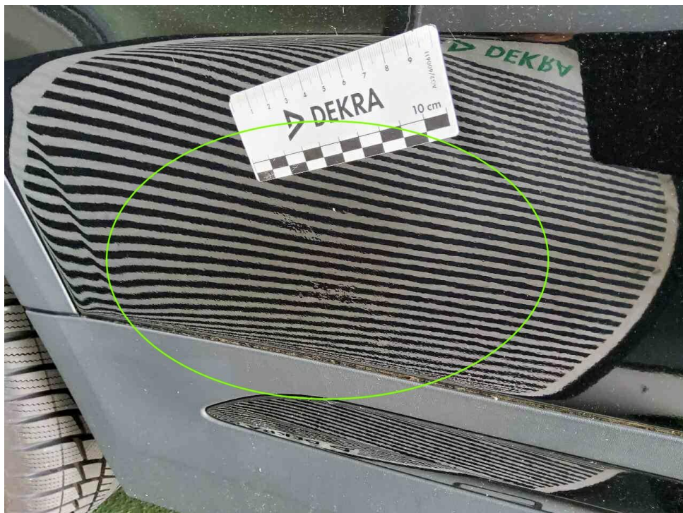
Bild 30 : Tür HR Reparatur Spuren sichtbar ua. Lackeinfall/ Wellig
