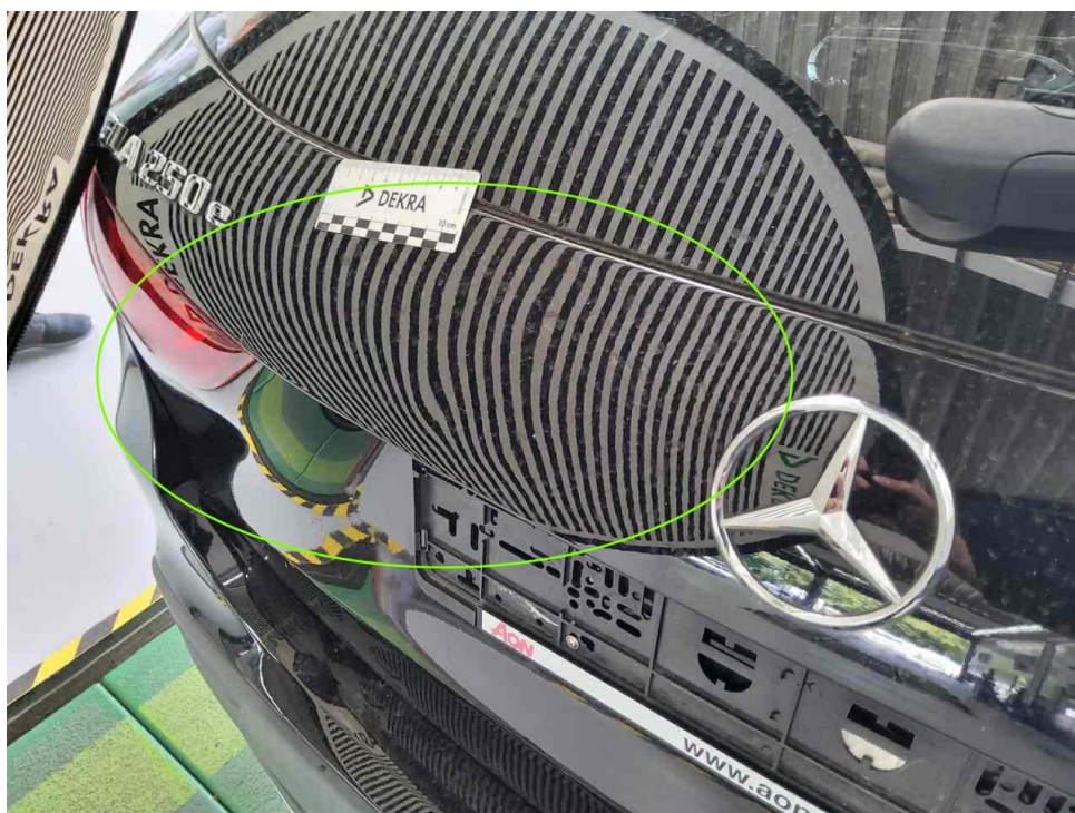
Bild 22 : Heckklappe, eingedellt, drücken
