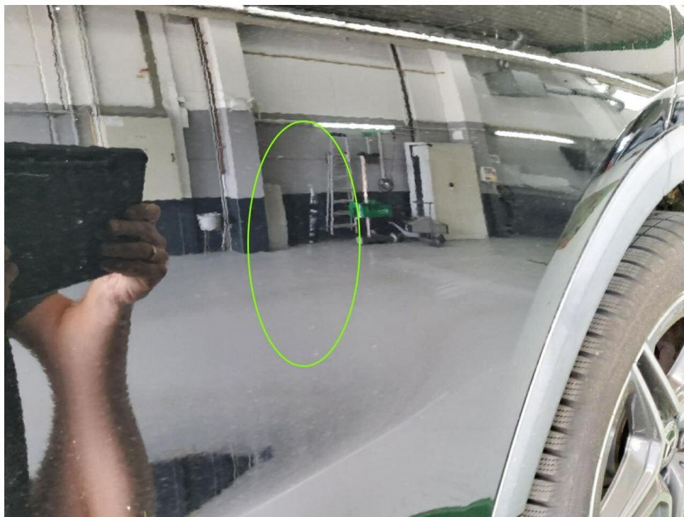
Bild 19 : Tür hinten links Lackierung, zerkratzt, polieren
