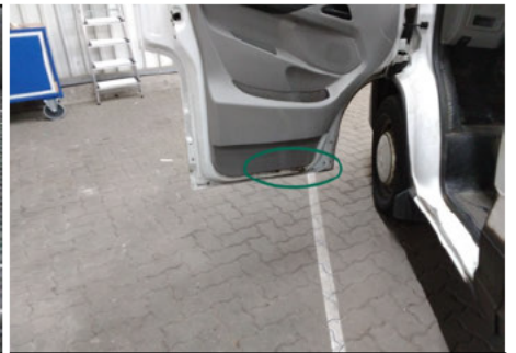
Tür / Innenraum Vorne Links / Abgewetzt
