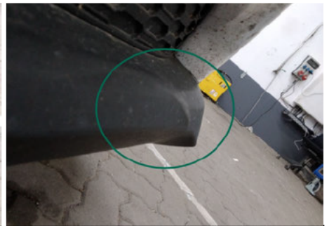
Stoßfänger unterhalb / Vorne / Delle
