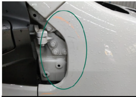
Kotflügel / Vorne Rechts / Kratzer
