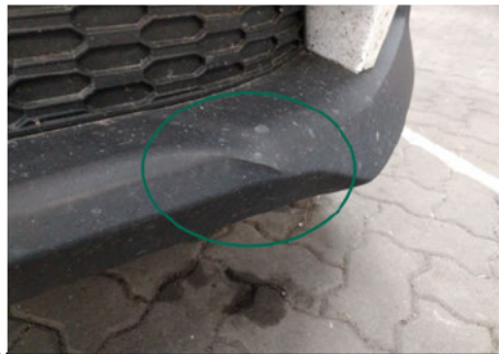
Stoßfänger unterhalb / Vorne / Delle
