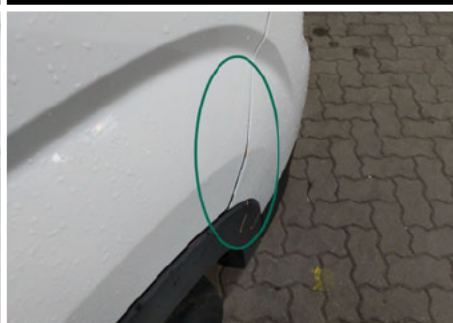
Stoßfängerhalter / Vorne Rechts / Defekt
