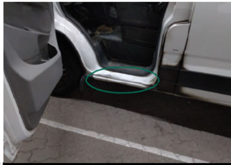
Türeinstieg / Vorne Links / Abgewetzt
