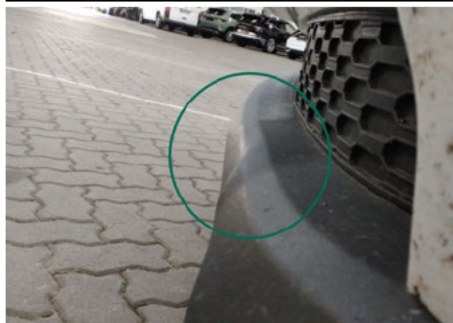
Stoßfänger unterhalb / Vorne / Delle
