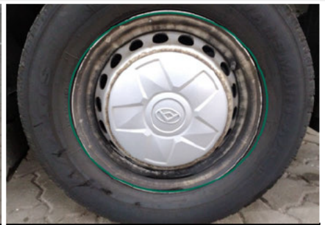
Felge / Vorne Links / Rost
