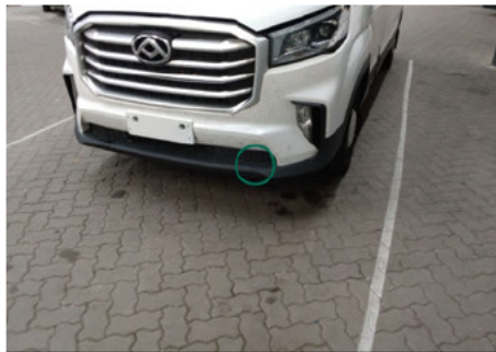
Stoßfänger unterhalb / Vorne / Delle
