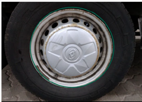
Felge / Hinten Rechts / Rost
