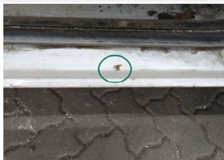
Türeinstieg / Rechts / Rost
