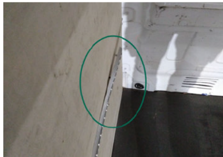
Laderaum Aluschiene / Unten Links / Defekt
