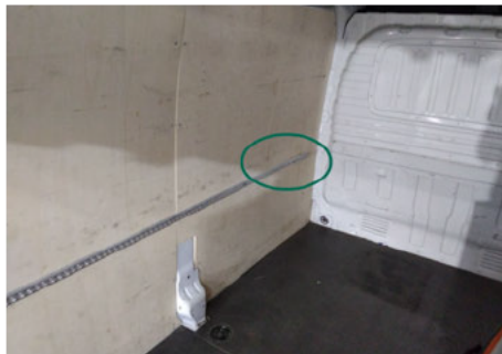
Laderaum Aluschiene / Unten Links / Defekt
