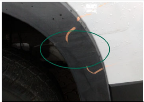
Kotflügelzerleiste / Vorne Rechts / Kratzer
