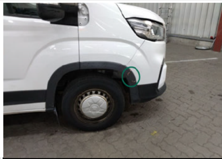
Kotflügelzerleiste / Vorne Rechts / Kratzer
