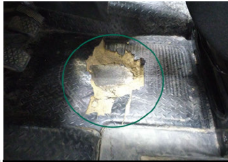
Fußmatten / Vorne Links / Gebrochen
