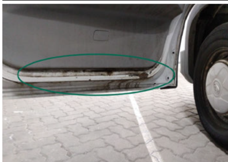
Tür / Innenraum Vorne Links / Abgewetzt
