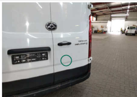
Heckklappe / Kofferraumtür / Unten Rechts / Delle
