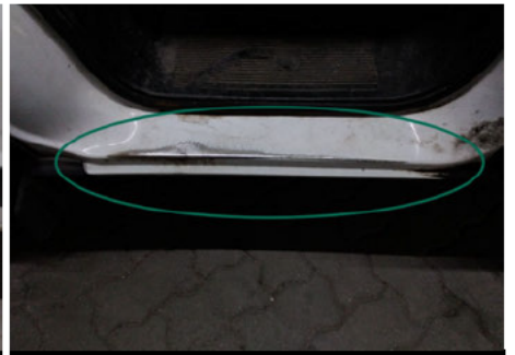
Türeinstieg / Vorne Links / Abgewetzt
