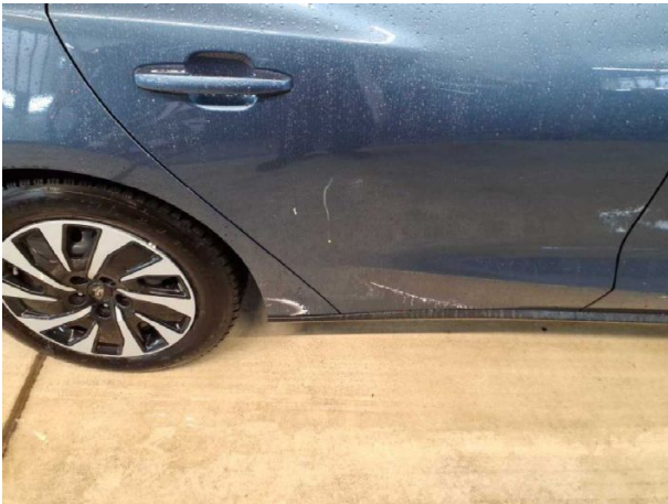
Beschädigung #5: Tür hinten rechts: Tür - verkratzt / verschürft - instandsetzen und lackieren
