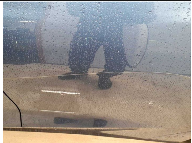
Beschädigung #4: Tür hinten links: Tür - verkratzt / verschürft... - instandsetzen und lackieren
