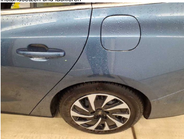
Beschädigung #6: Seitenwand links: Seitenwand - verkratzt / verschürft - instandsetzen und lackieren
