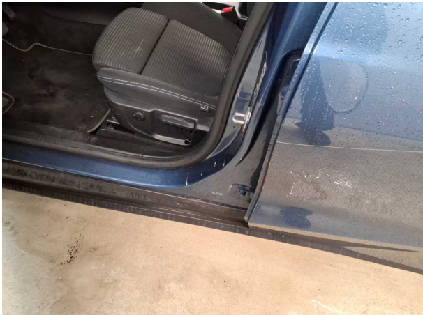
Beschädigung #2: Schweller links: Einstieg - Delle / Lackschade... Smart Repair
