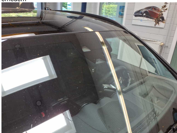
Beschädigung #4: Verglasung: Frontscheibe - Steinschlag - erneuern
