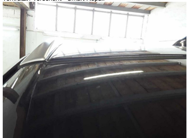
Beschädigung #3: Heckklappe/-tür: Heckklappe - Fehlstellung - einstellen/justieren
