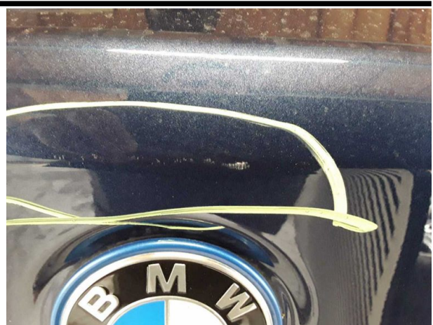
Beschädigung #6: Heckklappe/-tür: Heckklappe - verkratzt / verschürft - lackieren
