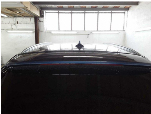
Damage #3: Boot lid / rear door: Boot lid - Malposition - Set / adjust
