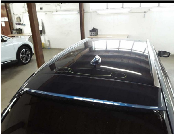
Beschädigung #8: Fahrzeugdach: Dach - verformt - instandsetzen und lackieren
