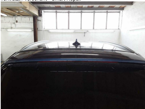
Beschädigung #3: Heckklappe/-tür: Heckklappe - Fehlstellung - einstellen/justieren
