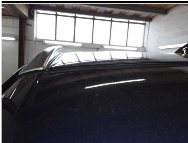
Beschädigung #3: Heckklappe/-tür: Heckklappe - Fehlstellung - einstellen/justieren
