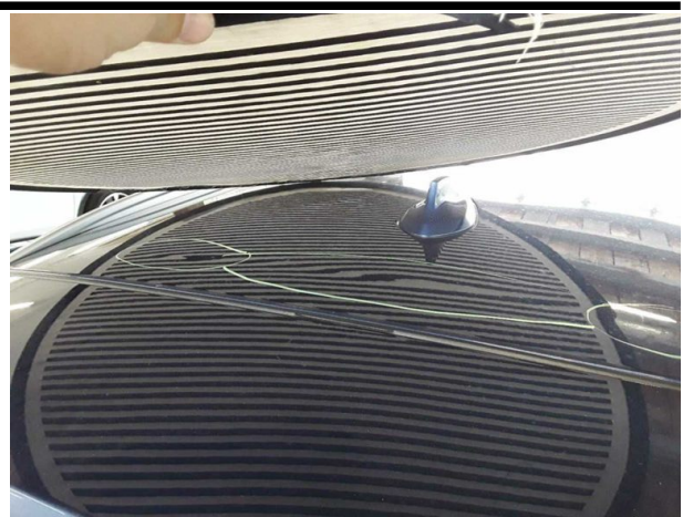
Beschädigung #8: Fahrzeugdach: Dach - verformt - instandsetzen und lackieren
