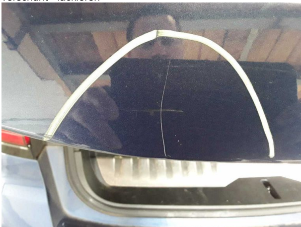
Beschädigung #6: Heckklappe/-tür: Heckklappe - verkratzt / verschürft - lackieren
