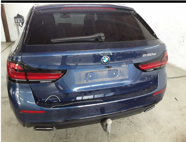
Beschädigung #6: Heckklappe/-tür: Heckklappe - verkratzt / verschürft - lackieren
