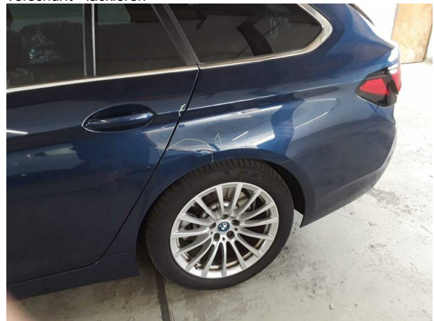
Beschädigung #7: Seitenwand links: Seitenwand - verformt - instandsetzen und lackieren
