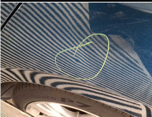
Beschädigung #5: Seitenwand links: Seitenwand - Delle(n) - sanft instandsetzen
