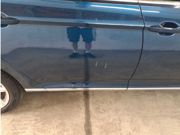
Beschädigung #2: Tür hinten rechts: Tür - Kratzer - auslegen / polieren
