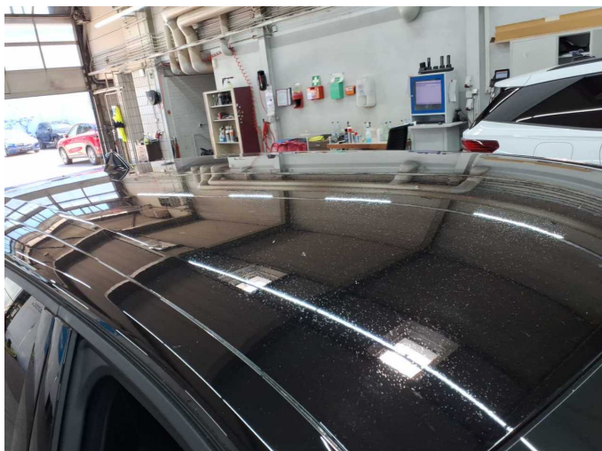
Damage 2: Roof: Roof (Anhaftung Harz-Mehrkosten möglich) - Paint defect - Conditioning
