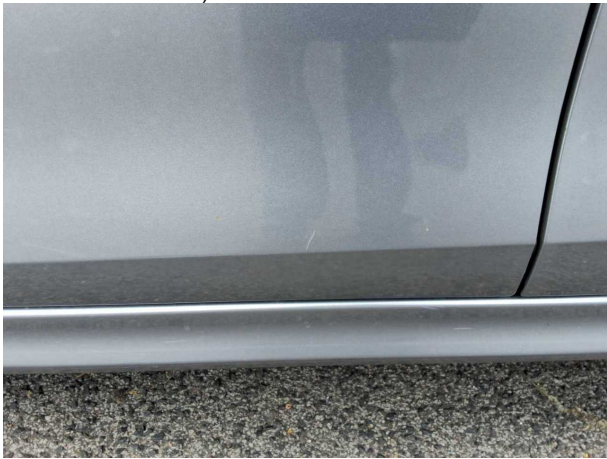
Beschädigung #14: Tür vorn links: Tür - Kratzer - lackieren
