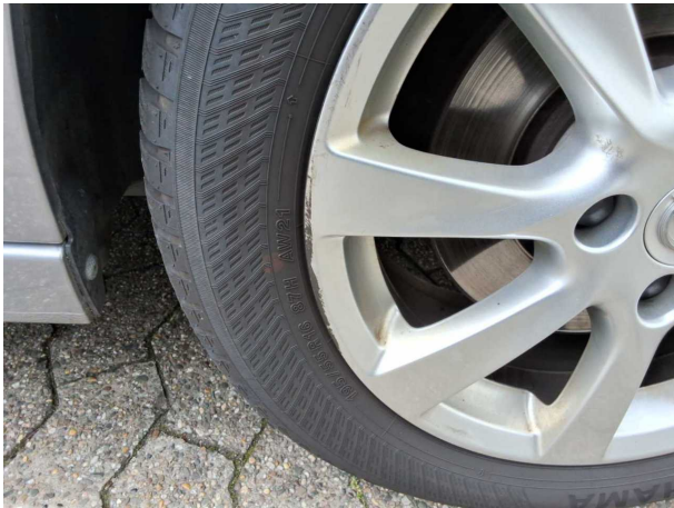
Beschädigung #5: Rad/Reifen: Leichtmetallfelge vorn rechts - Kratzer - erneuern
