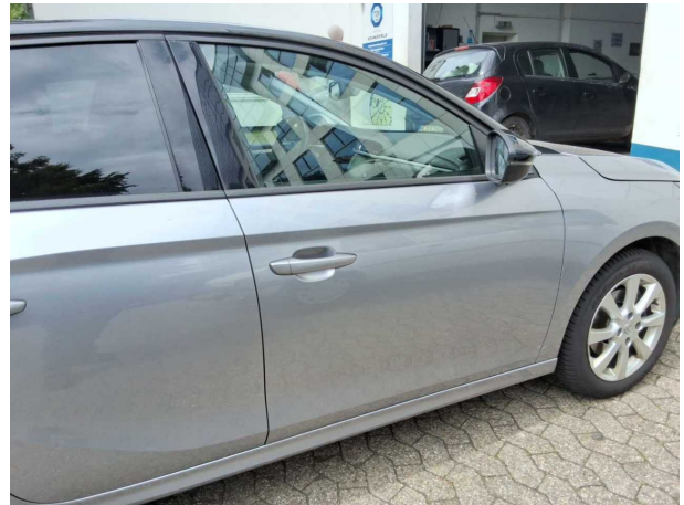
Beschädigung #15: Tür vorn rechts: Tür - Kratzer - lackieren
