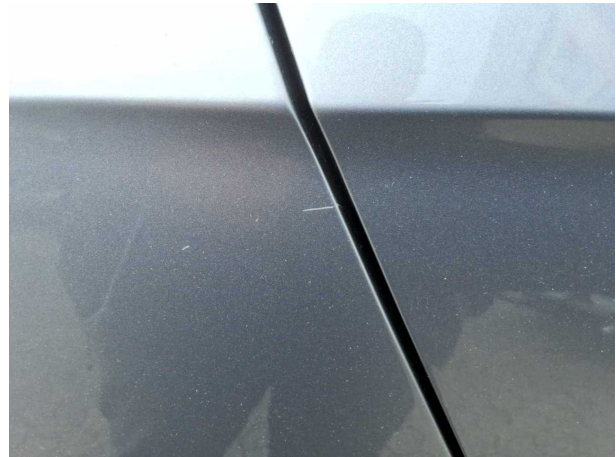
Beschädigung #11: Seitenwand rechts: Seitenwand - Kratze... lackieren
