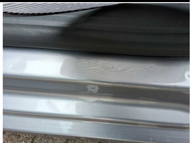
Beschädigung #18: Schweller links: Einstieg - Delle / Lackschaden - instandsetzen und lackieren
