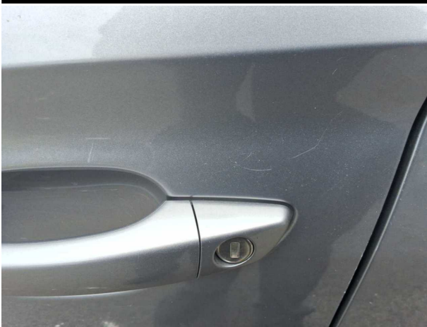
Beschädigung #14: Tür vorn links: Tür - Kratzer - lackieren
