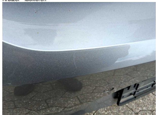
Beschädigung #12: Stossfänger hinten: Stossfänger hinten - Kratzer - lackieren
