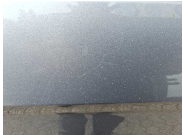
Beschädigung #10: Tür hinten rechts: Tür - Kratzer - lackieren
