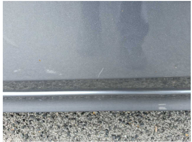
Beschädigung #14: Tür vorn links: Tür - Kratzer - lackieren
