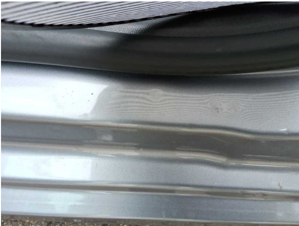
Beschädigung #18: Schweller links: Einstieg - Delle / Lackschad... - instandsetzen und lackieren
