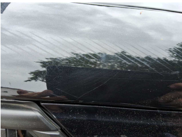
Beschädigung #16: Fahrzeugdach: Dachholm links - Kratzer - lackieren
