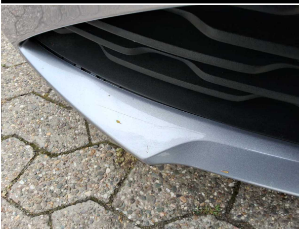
Beschädigung #17: Stossfänger vorn: Stossfänger vorn - Kratzer - lackieren
