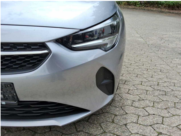
Beschädigung #17: Stossfänger vorn: Stossfänger vorn - Kratzer - lackieren
