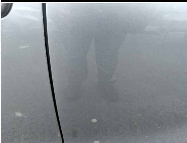
Beschädigung #9: Tür hinten links: Tür - Kratzer - lackieren
