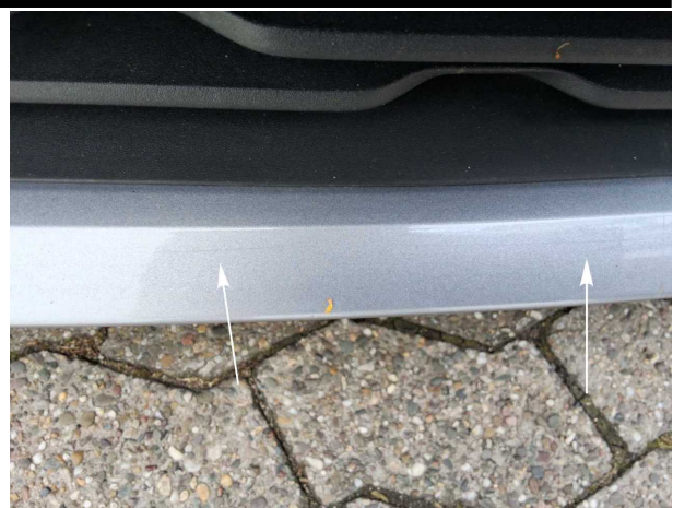
Beschädigung #17: Stossfänger vorn: Stossfänger vorn - Kratzer - lackieren
