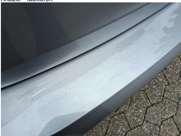
Beschädigung #12: Stossfänger hinten: Stossfänger hinten - Kratzer - lackieren
