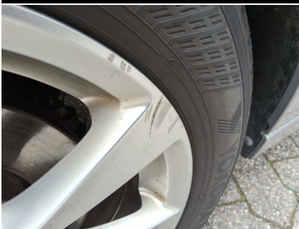
Beschädigung #4: Rad/Reifen: Leichtmetallfelge vorn links - Kratzer - erneuern
