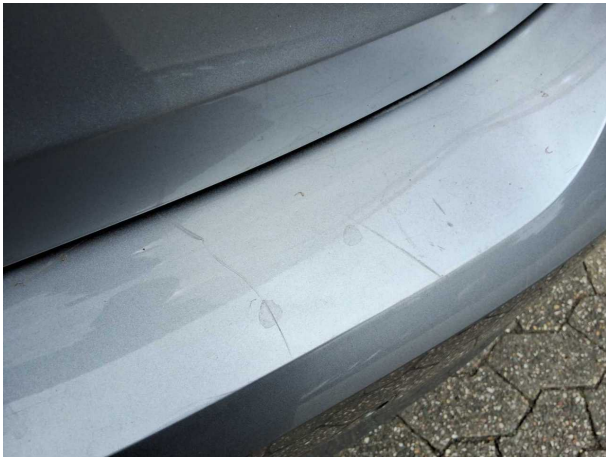
Beschädigung #12: Stossfänger hinten: Stossfänger hinten - Kratzer - lackieren
