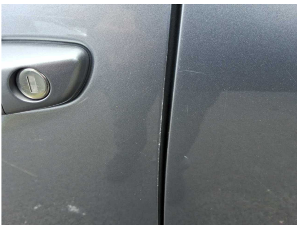
Beschädigung #14: Tür vorn links: Tür - Kratzer - lackieren
