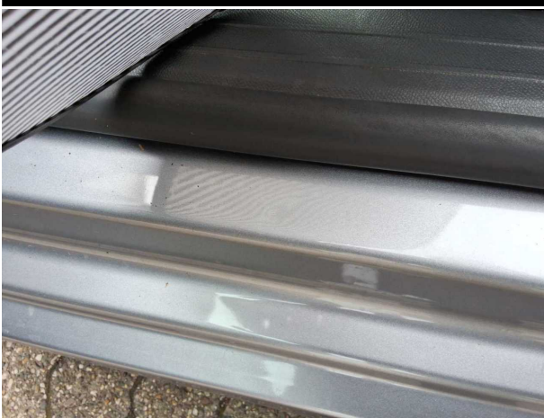
Beschädigung #18: Schweller links: Einstieg - Delle / Lackschad... - instandsetzen und lackieren
