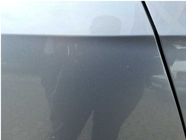
Beschädigung #11: Seitenwand rechts: Seitenwand - Kratzer - lackieren
