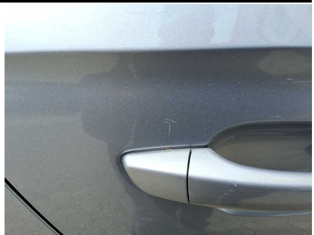
Beschädigung #10: Tür hinten rechts: Tür - Kratzer - lackieren
