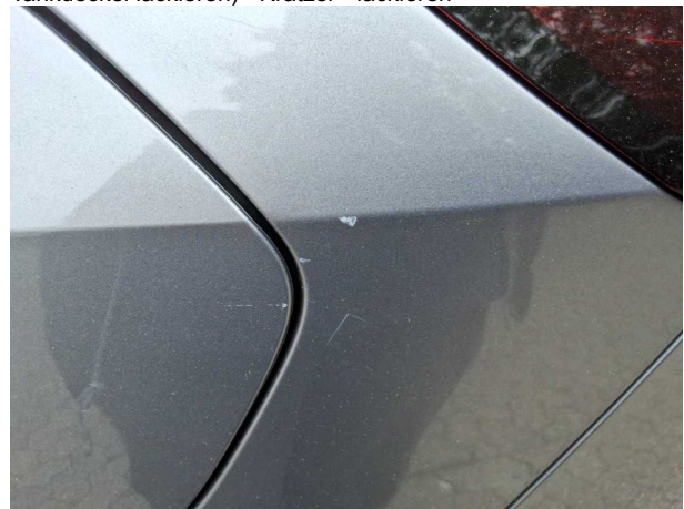
Beschädigung #13: Seitenwand links: Seitenwand (inklusive Tankdeckel lackieren) - Kratzer - lackieren
