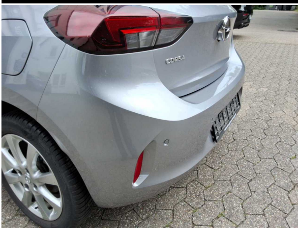
Beschädigung #12: Stossfänger hinten: Stossfänger hinten - Kratzer - lackieren
