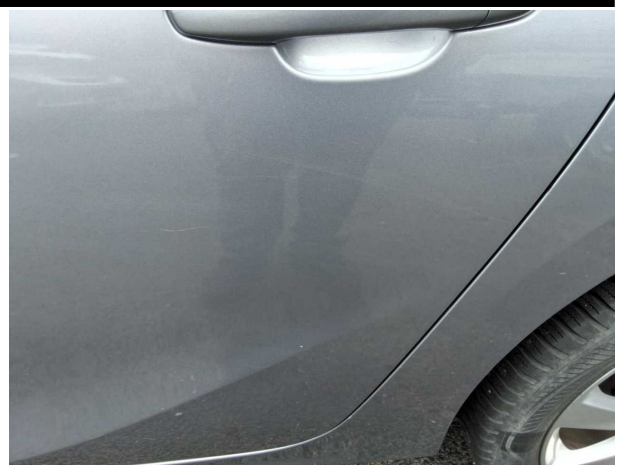
Beschädigung #9: Tür hinten links: Tür - Kratzer - lackieren
