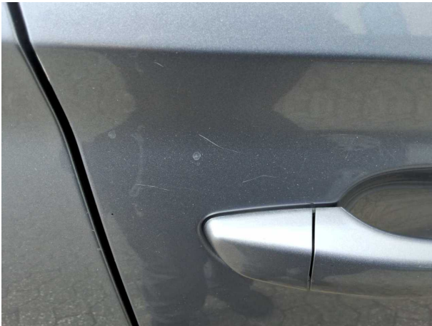
Beschädigung #15: Tür vorn rechts: Tür - Kratzer - lackieren
