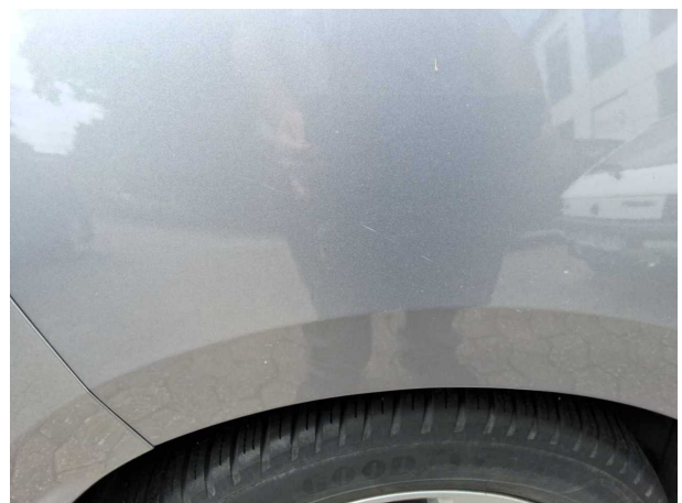
Beschädigung #11: Seitenwand rechts: Seitenwand - Kratze... lackieren
