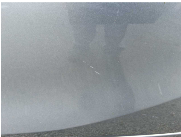
Beschädigung #9: Tür hinten links: Tür - Kratzer - lackieren
