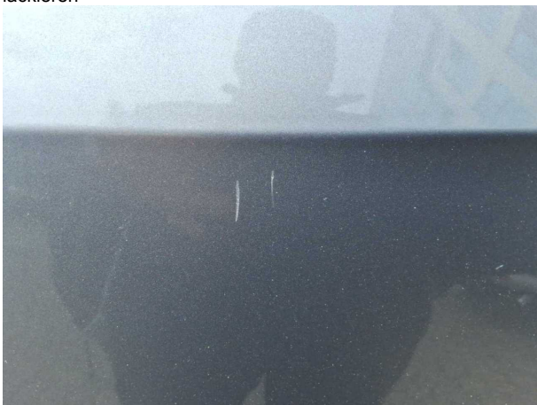
Beschädigung #11: Seitenwand rechts: Seitenwand - Kratzer - lackieren
