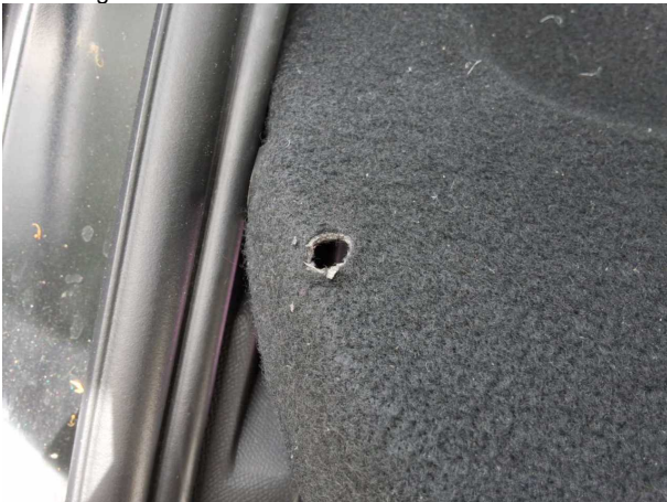
Beschädigung #3: Interieur: Hutablage (inklusive Halter) - beschädigt - erneuern
