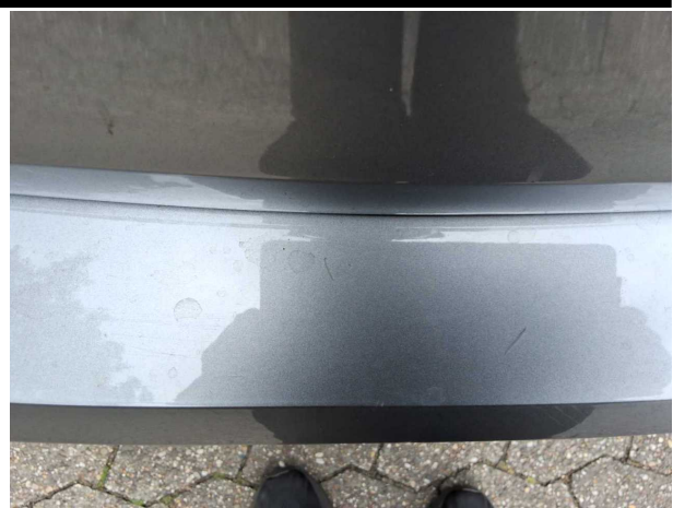
Beschädigung #12: Stossfänger hinten: Stossfänger hinten - Kratzer - lackieren
